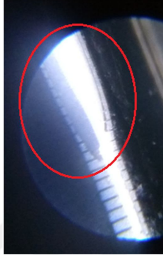
Şekil 5.10 Testte kullanılan termal başlığın mekaniksel bozulması
