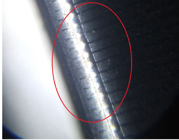
Şekil 5.8 Çoklu baskı yöntemi kullanılarak, 75 mm/s hızda, 10 mm şablonda 3.500.000 baskı sonrası ısıt hücre fotoğrafı
