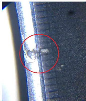
Şekil 5.11 Testte kullanılan termal başlığın mekaniksel bozulması
