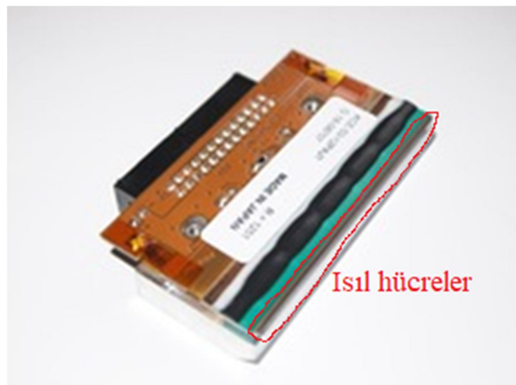
Şekil 3.28 Termal başlık ısıt hücrelerinin konumu
