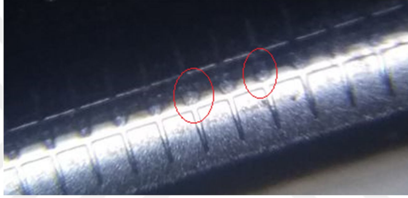
Şekil 5.7 Çoklu baskı yöntemi kullanılarak, 75 mm/s hızda, 10 mm şablonda 1.000.000 baskı sonrası ısıt hücre fotoğrafı
