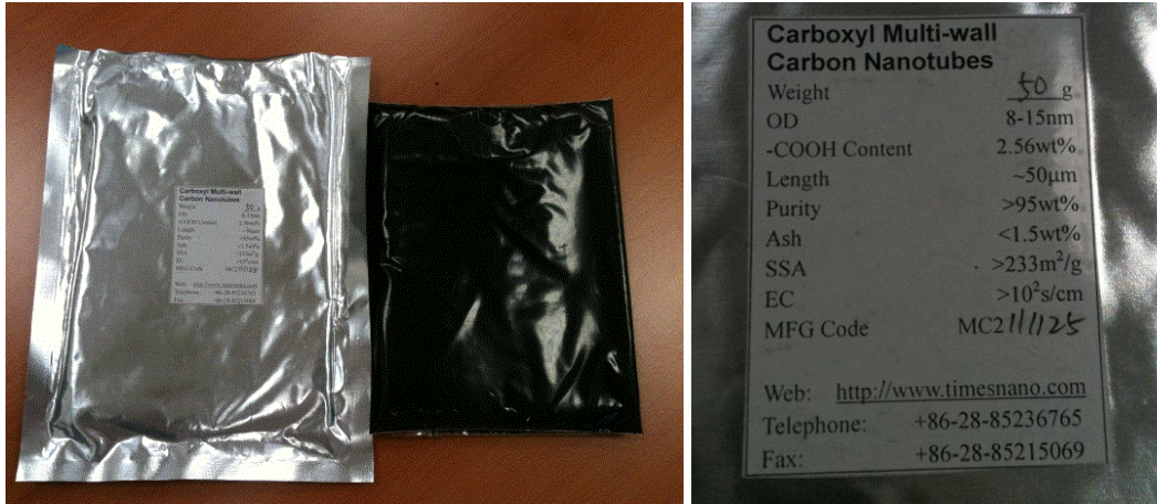
Şekil 3.5: 8-15 nm tanecik çapına sahip karbon nanotüp bilgileri.
