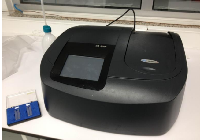
Şekil 3.16: Hach-Lange DR5000 marka spektrofotometre cihazı.
