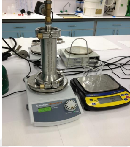
Şekil 3.14: Sterlitech HP4750 marka membran hücresi.
