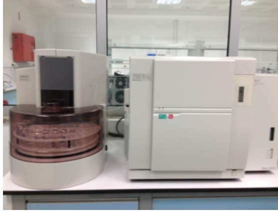
Şekil 3.15: Shimadzu VCP-N toplam organik karbon analiz cihazı.
