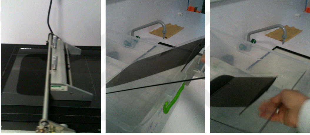
Şekil 3.7: CNT dop çözeltisinin bir cam tabaka üzerine SHEEN marka Otomatik Film Aplikasyon Cihazı ile dökülmesi.
