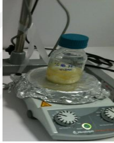
Şekil 3.1: PES/PVP çözeltisinin NMP içerisinde çözündürülmesi.
