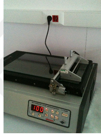
Şekil 3.3: PES/PVP çözeltisinin bir cam tabaka üzerine SHEEN marka Otomatik Film Aplikasyon Cihazı ile dökülmesi.
