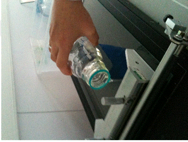
Şekil 3.3: PES/PVP çözeltisinin bir cam tabaka üzerine SHEEN marka Otomatik Film Aplikasyon Cihazı ile dökülmesi.
