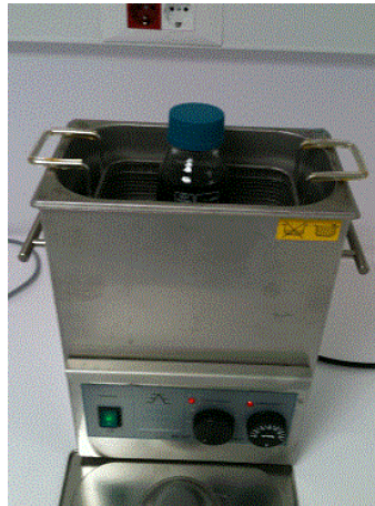
Şekil 3.1: PES/PVP çözeltisinin NMP içerisinde çözündürülmesi.
