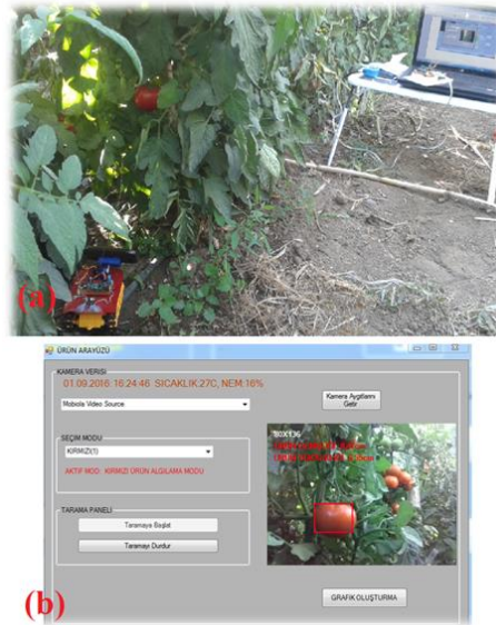
Şekil 4.2. Tarımsal ürün bilgilerinin bir gezgin robot yardımıyla temin edilen görüntülerin işlenmesi *a) genel görünüm (b) ürün tespit ve analiz
