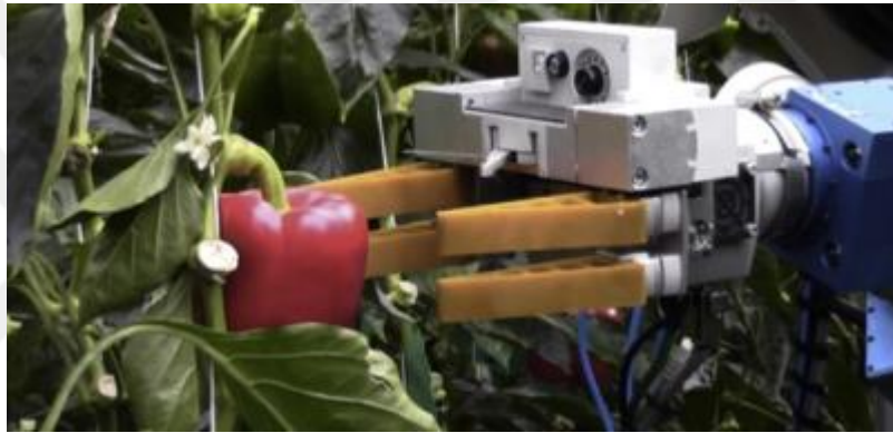
Şekil 2.63. Hem RGB hem de menzil kameralarını içeren algılayıcı teçhizata sahip olan tutucu ve manipülatör (Barnea et al. 2016)
