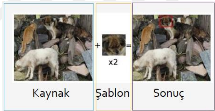
Şekil 1.25. Görüntü üzerinde şablon eşleme (Pişkin 2016b)
