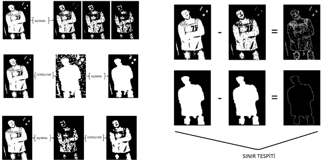
Şekil 1.20. Görüntüler üzerinde aşınma, genişletme ve sınır işlemleri (Anonymous 2017b)
