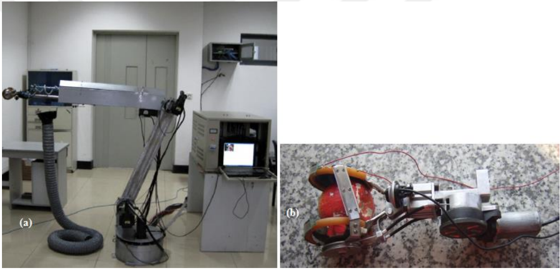
Şekil 2.53. (a) Manipülatör yapısı, (b) uç eleman (De-An et al. 2011)
