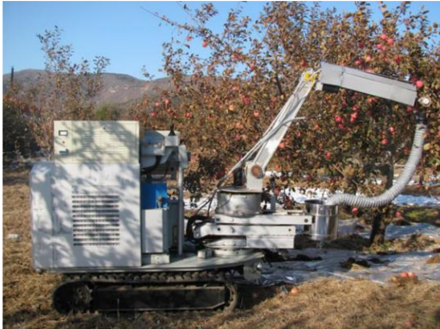
Şekil 2.54. Meyve bahçesinde elma hasat robotu test görüntüsü (Ji et al. 2012)
