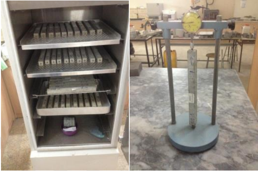
Şekil 3.5. İklimlendirme kabini ve kuruma rötresi ölçüm seti
