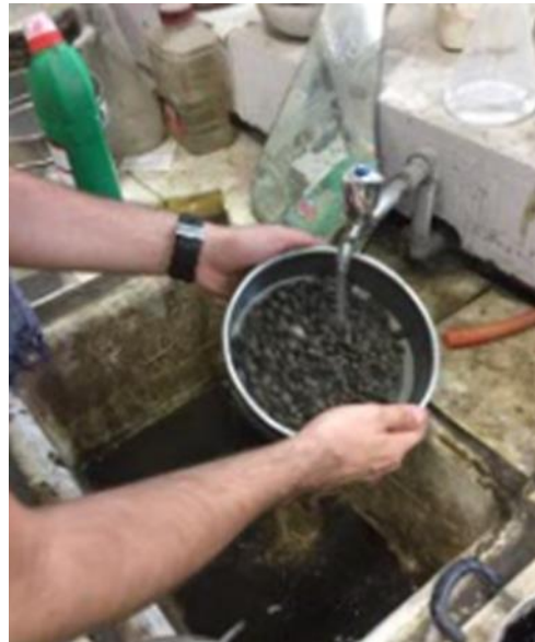
Şekil 5.24: Numunelerin su altında yıkanması.
