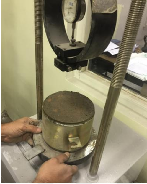
Şekil 5.30: Hazırlanmış olan CBR numunesinin deney aletine yerleştirilmesi.
