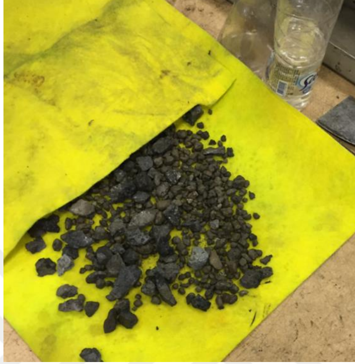
Şekil 5.21: Doygun kuru yüzey özgül ağırlık tayini.
