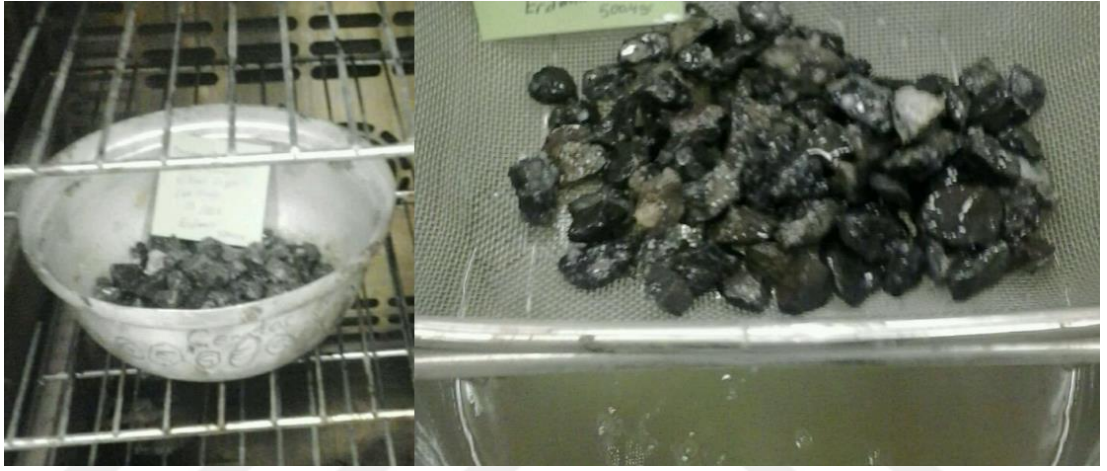
Şekil 5.16: Etüvde kurutulan numune ve çözeltiden süzülen numune.
