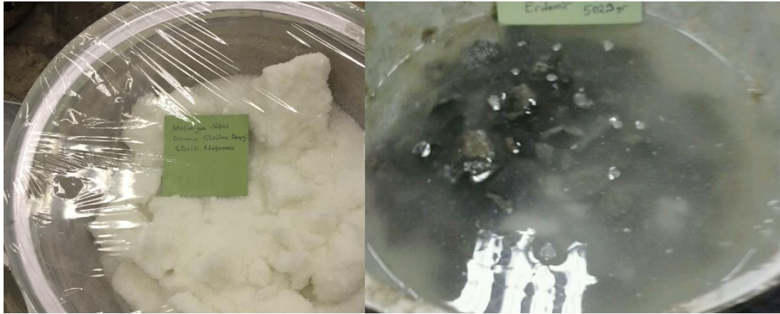
Şekil 5.15: Magnezyum sülfat çözelti malzemesi ve hazırlanmış çözeltiye koyulmuş numune.
