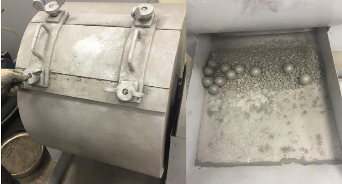
Şekil 5.18: Los Angeles deney makinası ve deneyin yapılışı.
