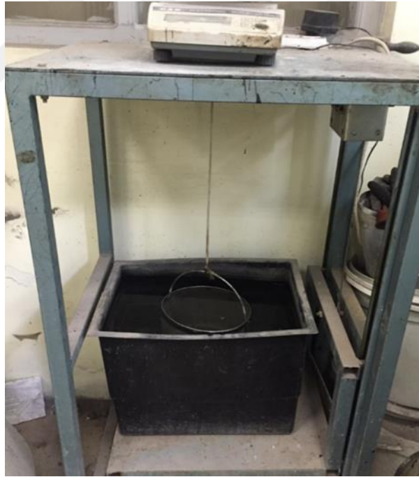
Şekil 5.20: Tel sepet ile numunelerin su içerisinde tartılması.
