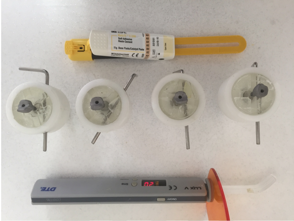
Şekil 3-16: Simantasyon ve vida boşluğu temizliği sonrası kuronların görünümü
