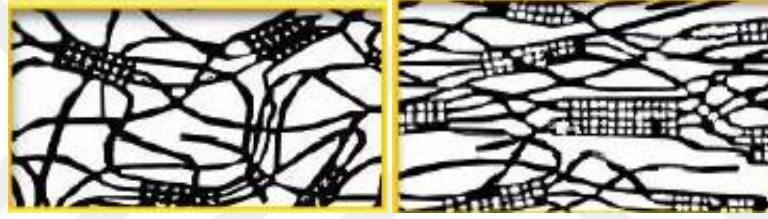
Şekil 2.21: Germe yapılmamış filament (sol) ve germe yapılmış filamentin (sağ) mikro yapısına ait şematik gösterim [25].
