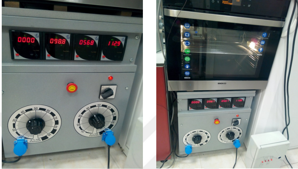
Şekil 3.12. Fırınlara bağlantısı yapılan güç kaynağı.
