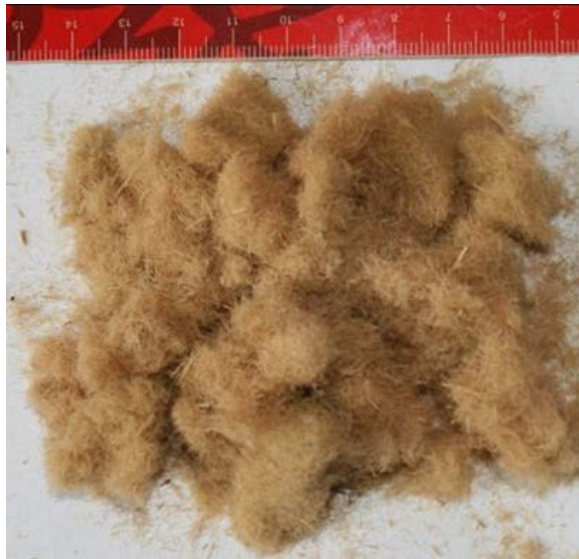
Şekil 3.5: 0.4 mm disk açıklığında elde edilen çam lifleri.
