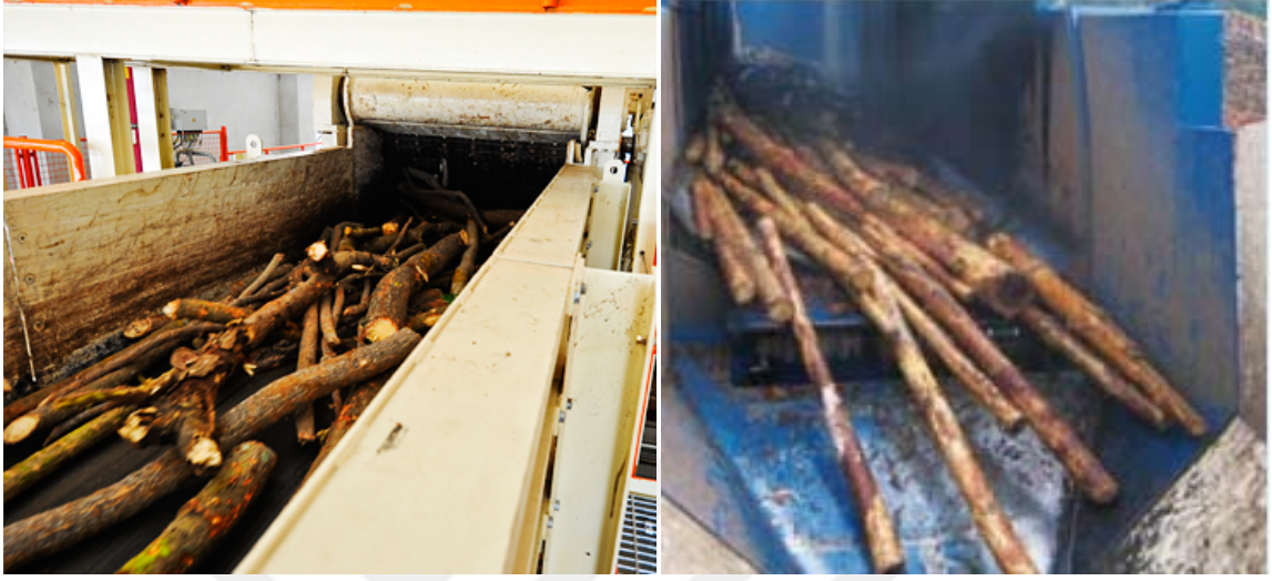
Şekil 2.4: Kabuk soyma makinası, Siemplkamp.
