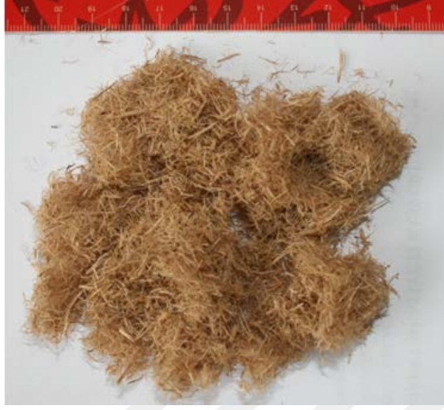
Şekil 3.8: 0.8 mm disk açıklığında elde edilen kayın lifleri.
