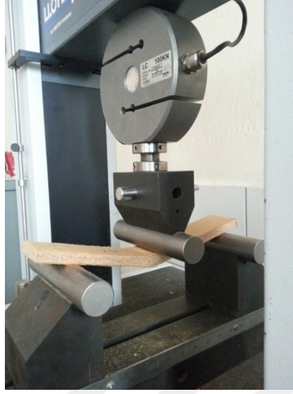
Şekil 3.17: Eğilme direnci deneyi (İ.Ü. Orman Fak. Mekanik lab.).
