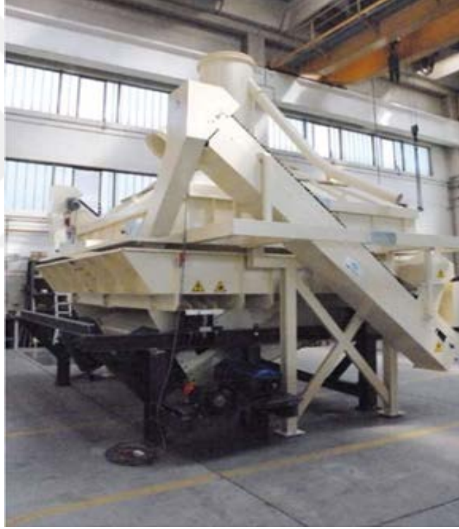
Şekil 2.7: Yonga yıkama makinesi, Siempelkamp MDF üretim tesisleri.
