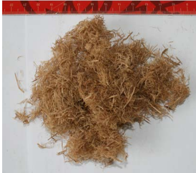
Şekil 3.7: 1.0 mm disk açıklığında elde edilen kayın lifleri.
