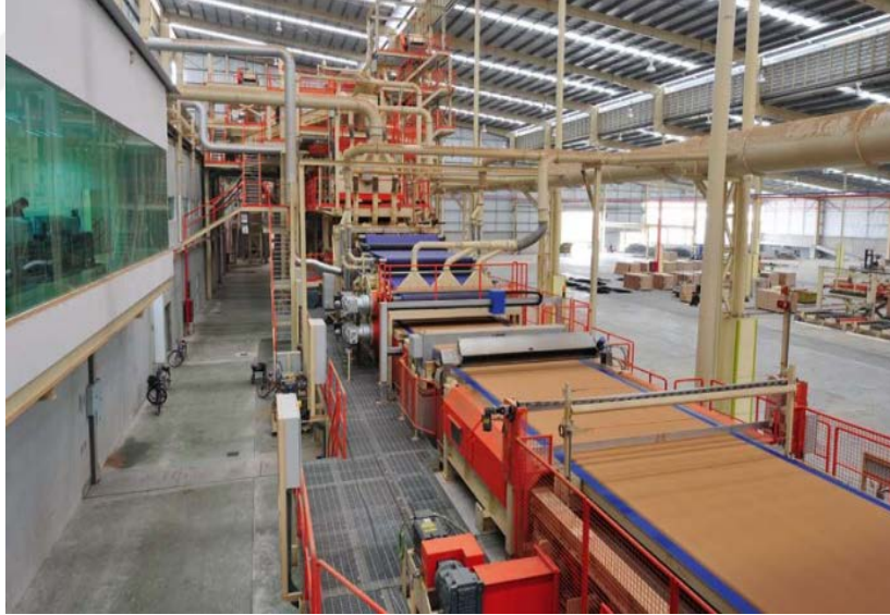
Şekil 2.13: Sürekli ön pres, Siempelkamp, MDF üretim tesisleri.
