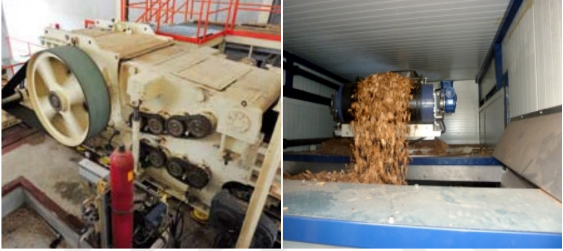
Şekil 2.5: Yongalama makinesi, Siempelkamp MDF üretim tesisleri.
