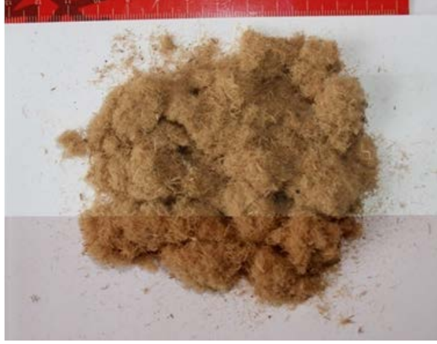
Şekil 3.10: 0.4 mm disk açıklığında elde edilen kayın lifleri.
