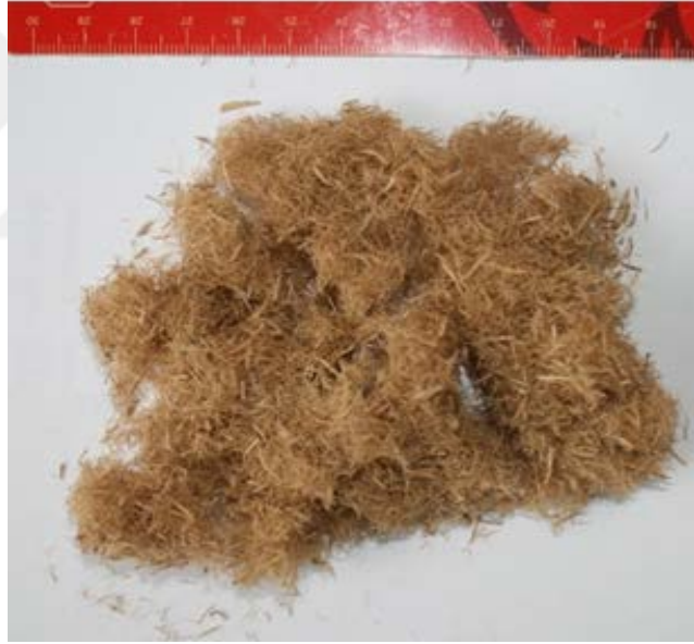
Şekil 3.9: 0.6 mm disk açıklığında elde edilen kayın lifleri.
