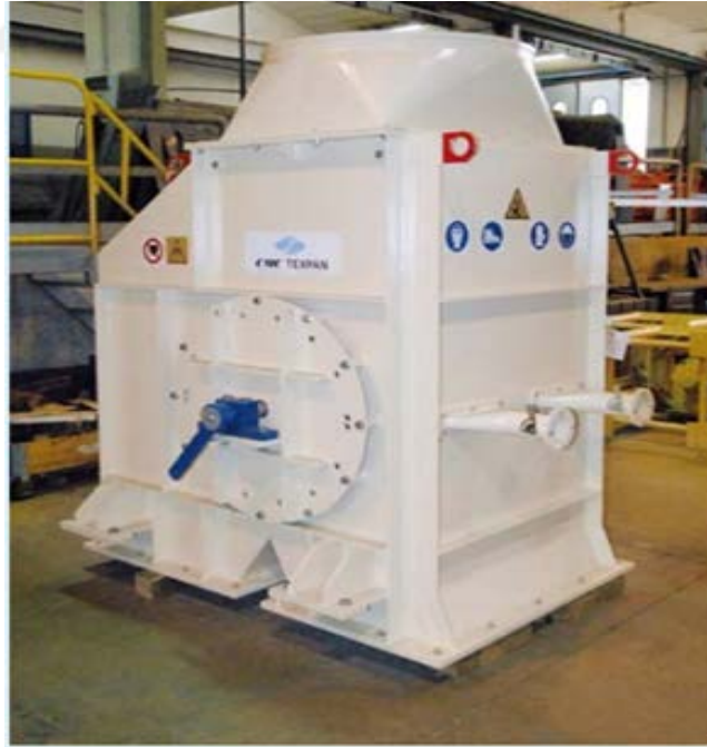
Şekil 2.6: Manyetik eleme makinesi, Siempelkamp MDF üretim tesisleri.
