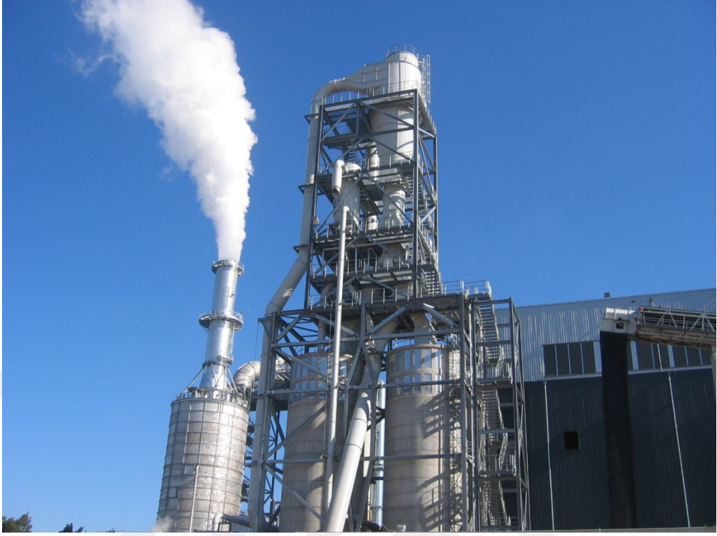
Şekil 2.10: Lif kurutma hattı, Siempelkamp MDF üretim tesisleri.
