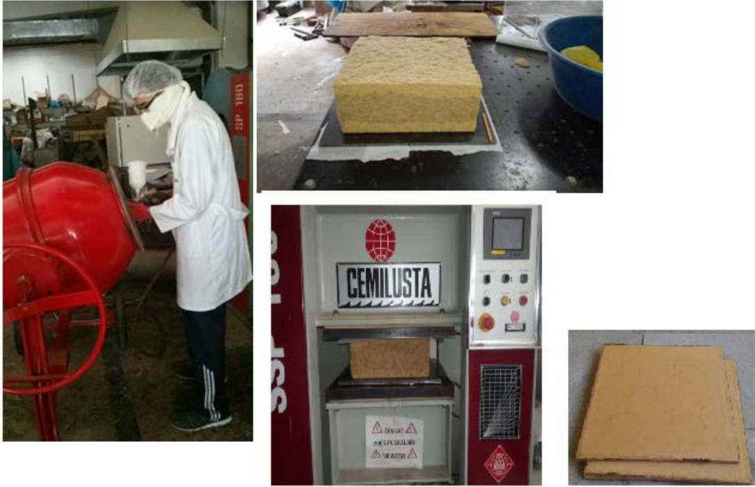
Şekil 3.11: Laboratuvarıda MDF üretim safhasının önemli kısımları verilmiştir.
