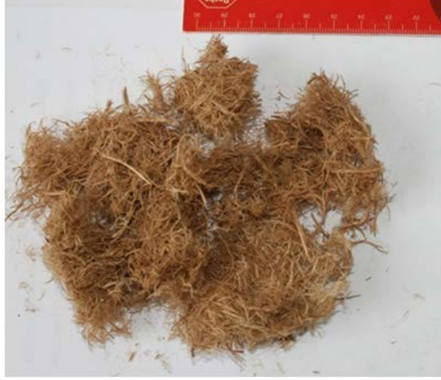
Şekil 3.6: 1.2 mm disk açıklığında elde edilen kayın lifleri.
