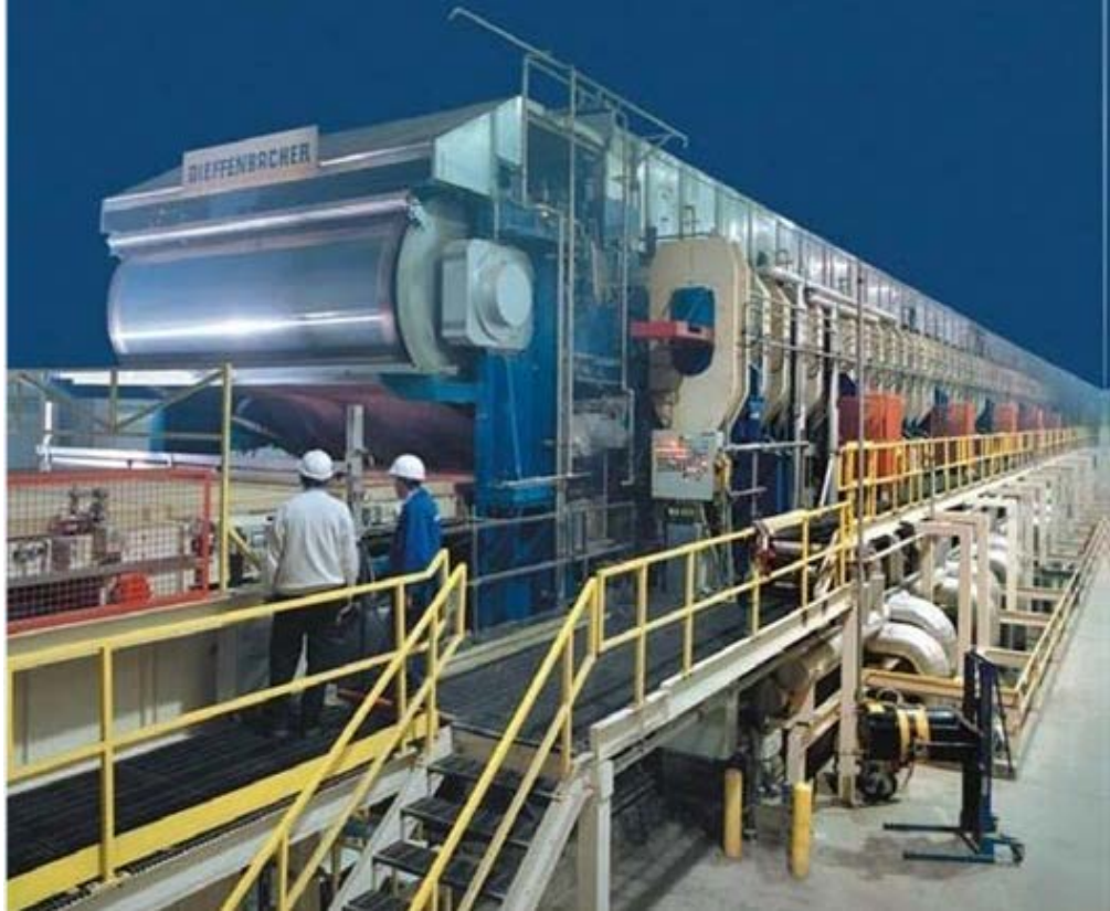
Şekil 2.14: Sürekli presin genel görünüşü, Siempelkamp MDF üretim tesisleri.
