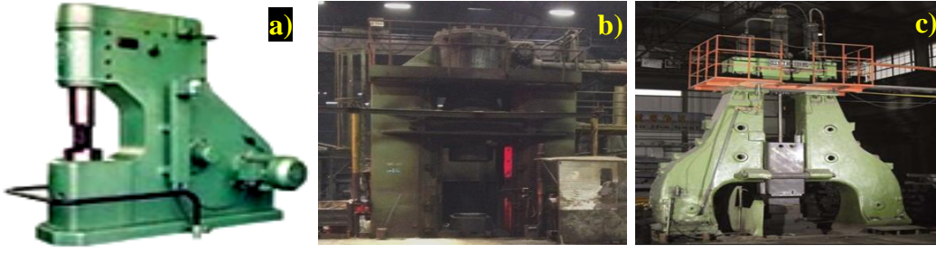
Şekil 2.1. Dövme Makinaları: a) Tek başlıklı tezgâh, b) Çift başlıklı dövme tezgâhı, c) Kontrollü enerji akışlı tezgâh.
