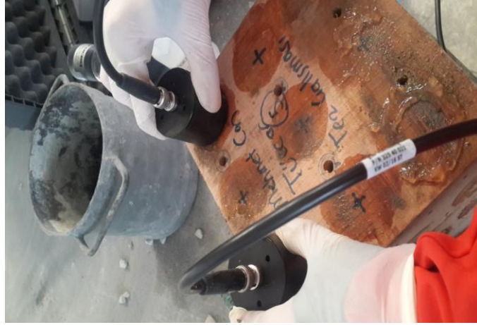
Şekil 1.41 : Tahribatlı numunede tek yüzeyde yapılan okuma.
