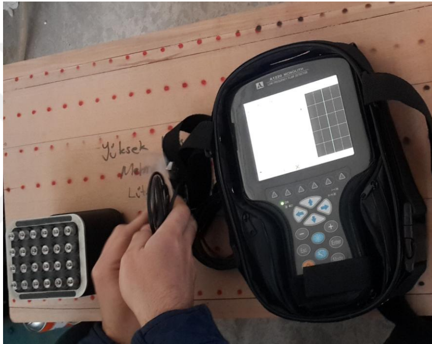
Şekil 1.48 : A1220 monolith aleti.
