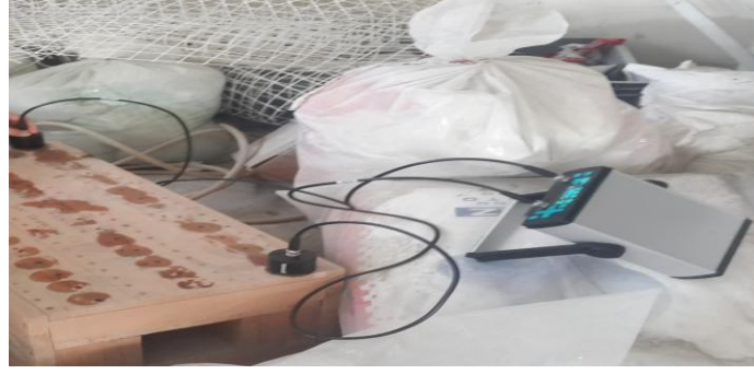
Şekil 1.28 : Ultrases hızı deney cihazı. (transduserler ile birlikte)
