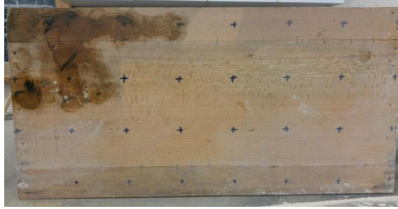
Şekil 1.20 : İçi boş 36*36*72 cm boyutlara sahip numune. (yandan görünüş)
