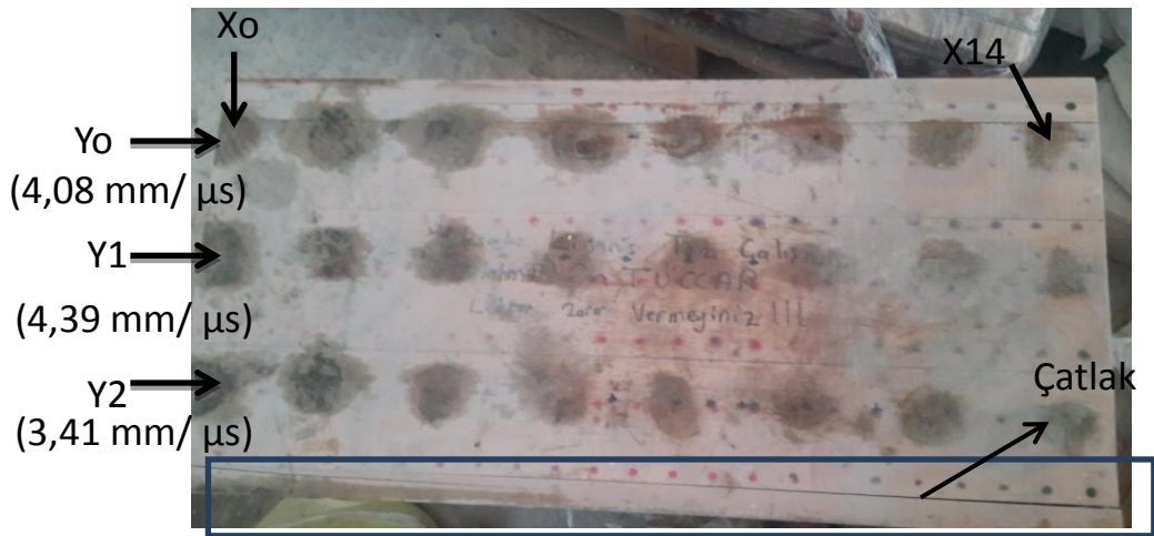
Şekil 3.13 : Kare prizma numunede hız ve bölge gösterimi.
