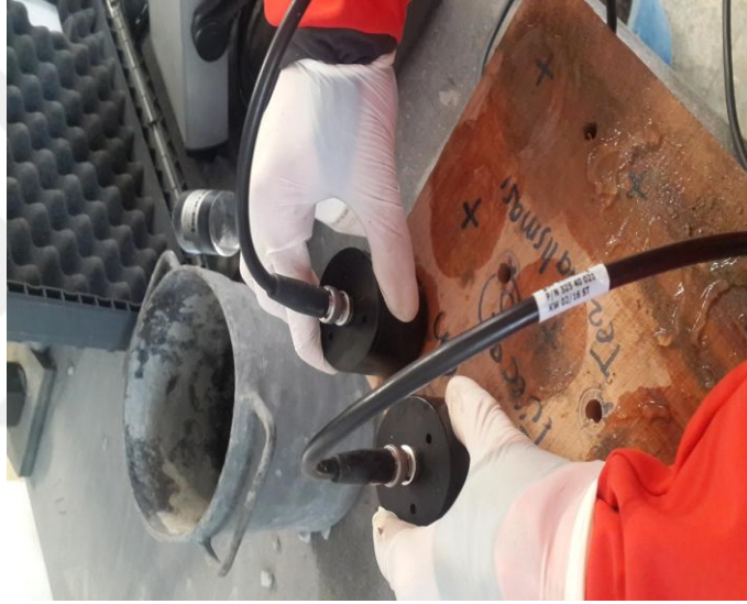
Şekil 1.42 : Tahribatlı numunede tek yüzeyde yapılan diğer okuma.
