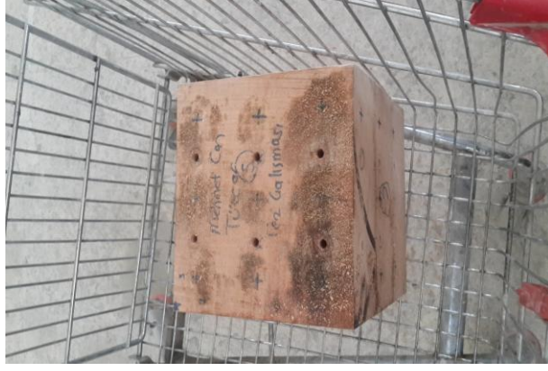
Şekil 1.26 : 20*20*20 cm boyutlara sahip tahribata uğramış küp numunenin 5 numaralı yüzü.
