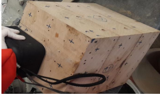
Şekil 1.55 : Tahribatlı numunede okuma işlemi.
