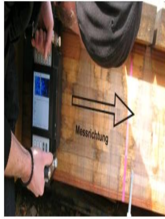
Şekil 1.15 : Ultrasonik muayene tekniğinin uygulanışı [48]
