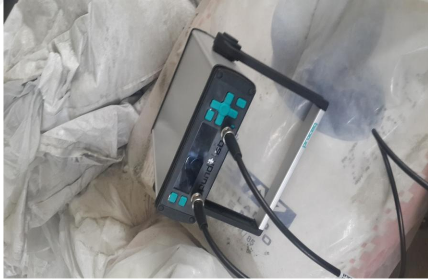
Şekil 1.27 : Ultrases hızı deney cihazı.
