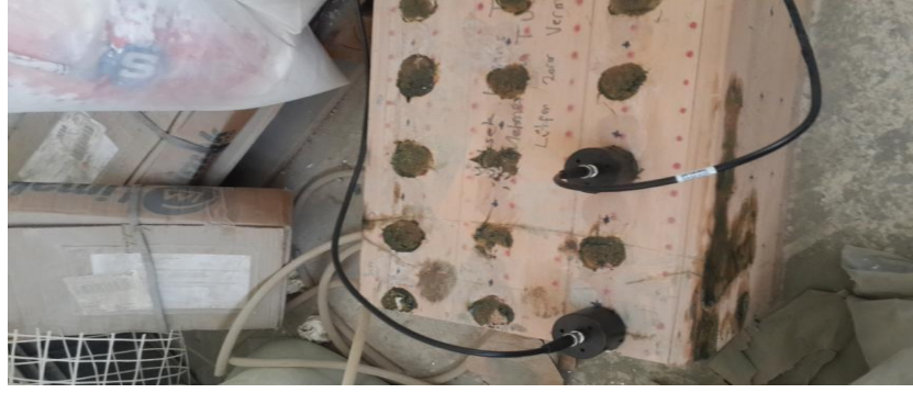
Şekil 1.46 : Yüzeyde indirekt okuması 2.aşama.
