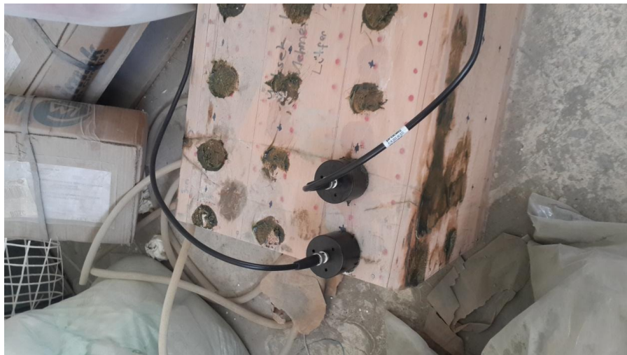
Şekil 1.45 : Yüzeyde indirekt okuması 1. aşama
