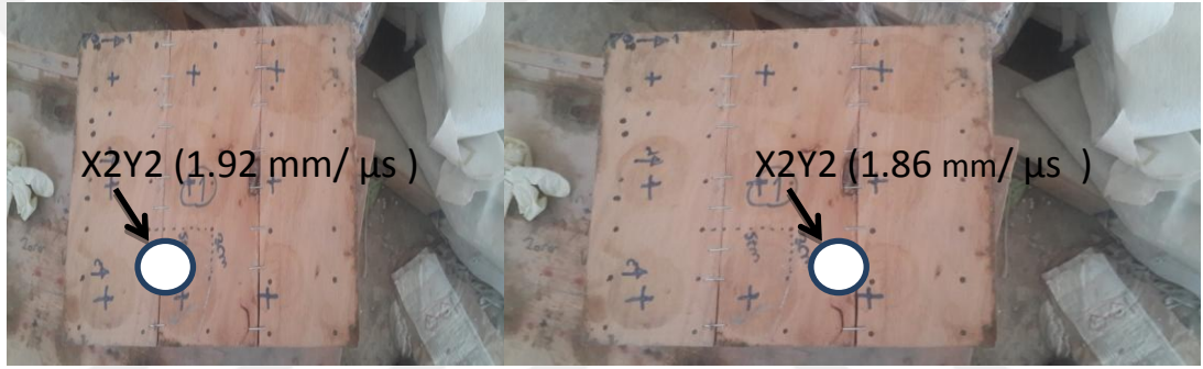
 ekil 3.14 : K p numunede hız ve b lge g sterimi.
