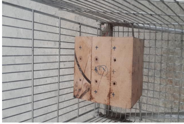
Şekil 1.24 : 20*20*20 cm boyutlara sahip tahribata uğramış küp numunenin 3 numaralı yüzü.
