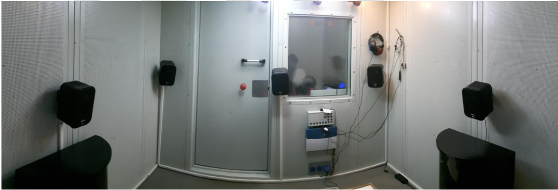
Şekil 3.8. Bu çalışmada kullanılan oda içindeki beş-hoparlör dizisi.
