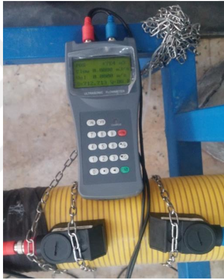
Şekil 4.3. Ultrasonik debi metre
