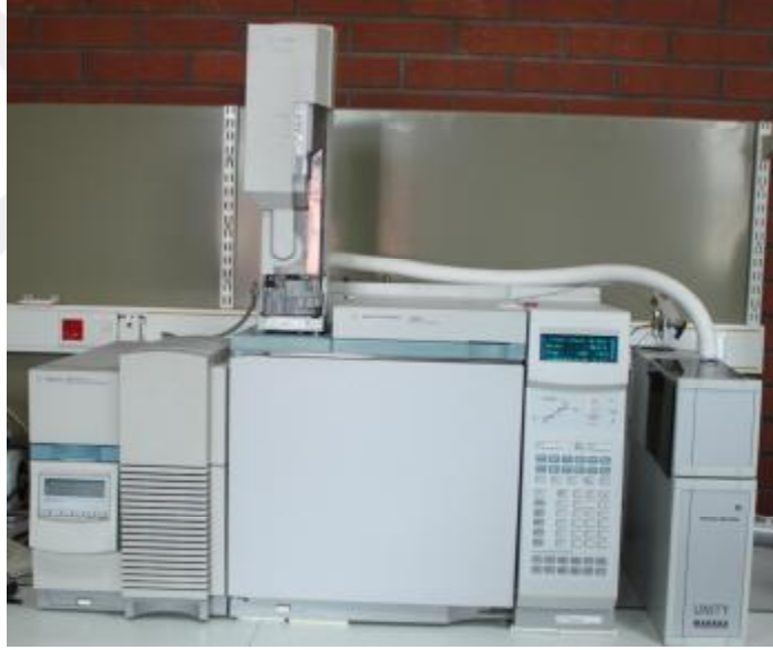
Şekil 3.3. Esansiyel yağların kimyasal bileşimlerini belirlemek için kullanılan GC-MS sistemi.
