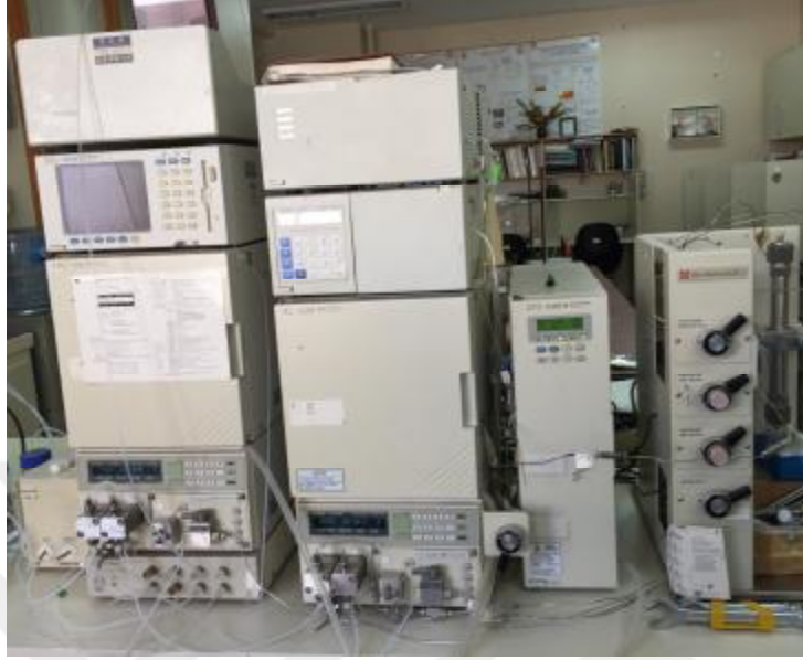
Şekil 3.11. Naringin analizlerinde kullanılan HPLC sistemi
