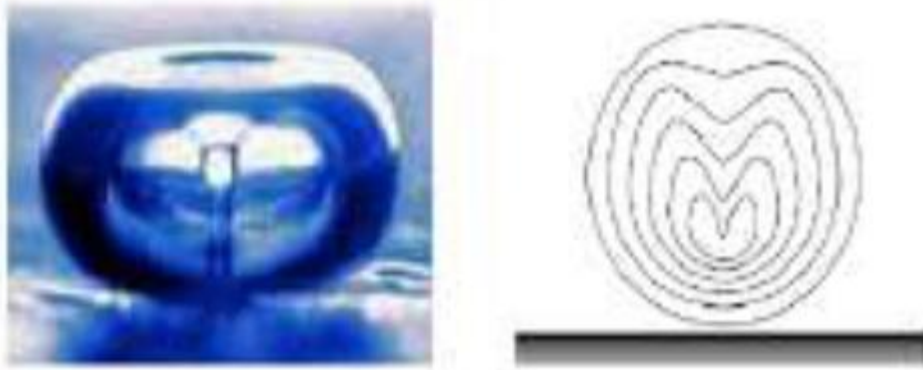
Şekil 2.6. Kavitasyon baloncuğunun oluşumu ve katı yüzey yakınında kavitasyon mikrojeterleri (Duran, 2006).
