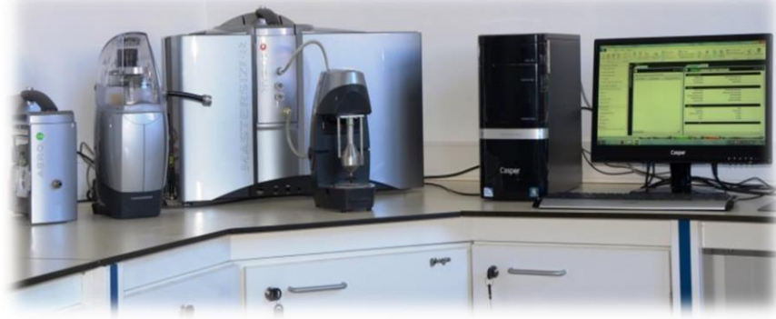
Şekil 2.3. Malvern marka tane boyut dağılımı analizi cihazı.
