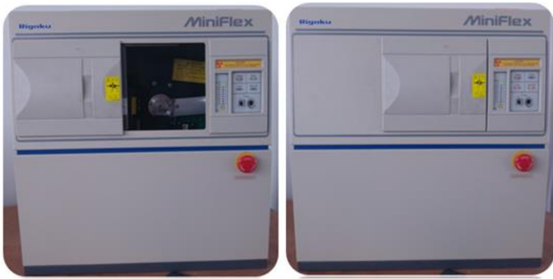
Şekil 2.2. Rigaku marka XRD cihazının görünümü.
