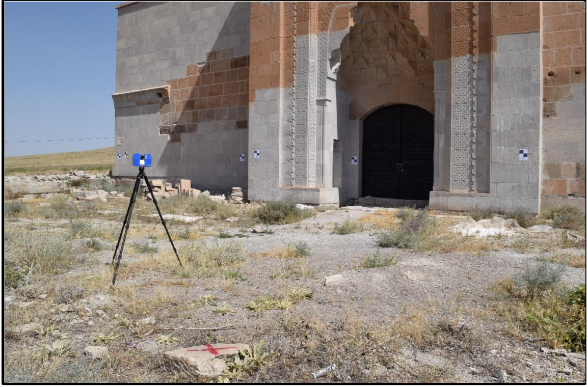
Şekil 4.4. Yersel lazer tarama aşamasından bir görüntü
