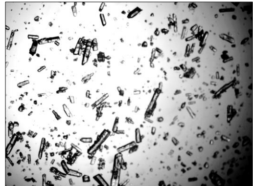
Şekil EK-1.11. CMSMPR tipi kristalizörde, 5 ppm PEO katkısı varlığında, üretilen borik asit kristallerinin mikroskop görüntüleri (T:90-60°C, 250 rpm, 3τ:180 dk, Q:80 mL/dk, V CMSMPR :5L)
