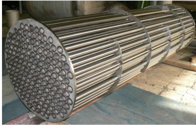
Şekil 3.12 Boru Tip Egzoz Eşanjörünün iç yapısı.
