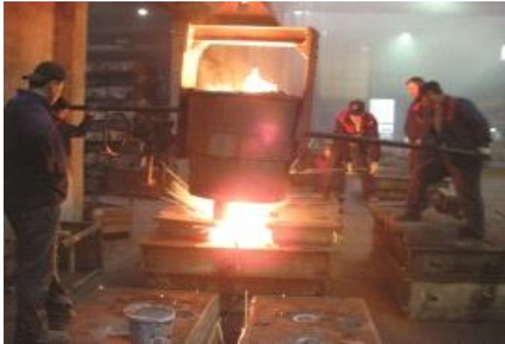
Şekil 3.3. Şarjın kum kalıba dökülmesi
