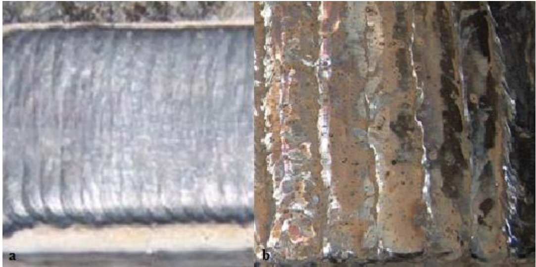
Şekil 3.20. Dolgu kaynağı tamamlanmış (a) ve sonrasında taşlama yapılan (b) numune
