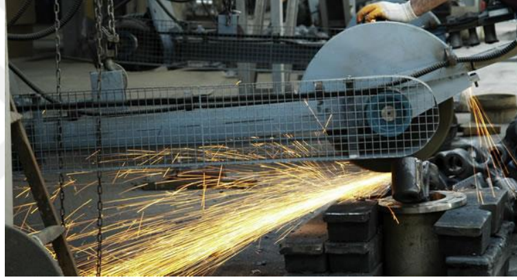
Şekil 3.5. Yolluk ve besleyicilerin taşlanması
