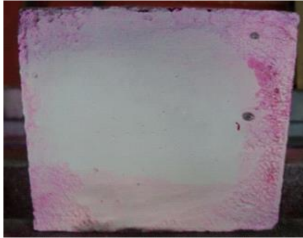
Şekil 4.16. Sıvı penetrant testi sonucunda ortaya çıkan temiz yüzey
