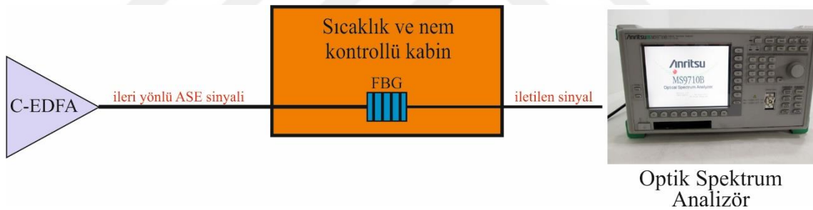
Şekil 3.4. Sıcaklık ve bağıl nem ölçümleri için kurulan deneysel düzenek.
