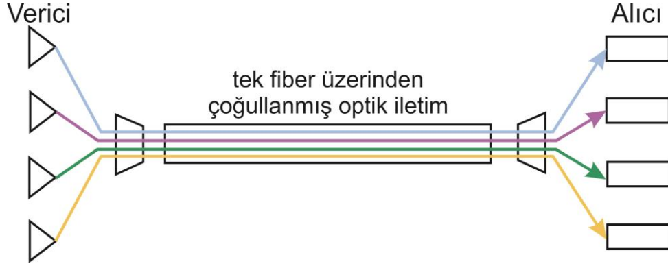
Şekil 1.5. DWDM sistemlerde sinyal iletimi.
