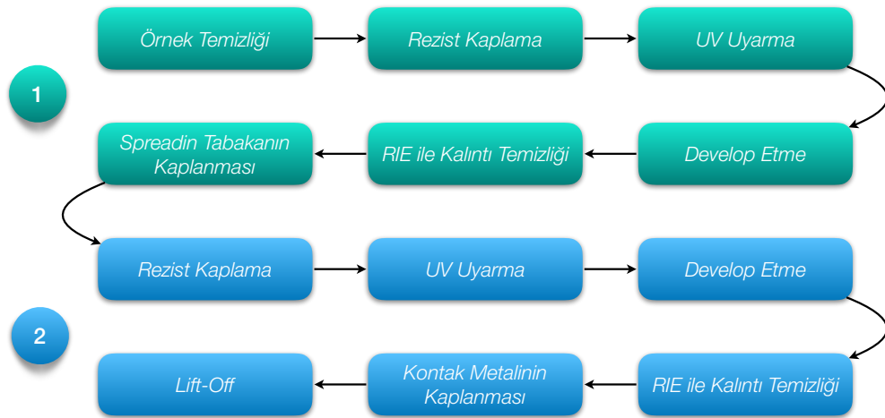
Şekil 3.4 InAs/InP ve InAs/GaAs tabanlı lazer yapılar için izlenen litografi işlem adımları
