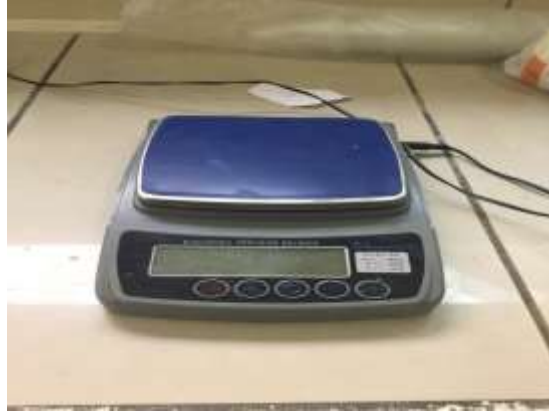
Şekil 16: Çalışmada kullanılan Dikomsan marka elektronik hassas terazi (hassasiyet 10^{-3} ).
