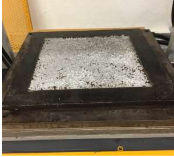
Şekil 21: Alt kalıp üzerine yerleştirilen DYPE cipsleri.
