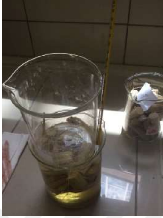
Şekil 13: Konvansiyonel yöntemle yüzey işleme gören mısır sapları.
