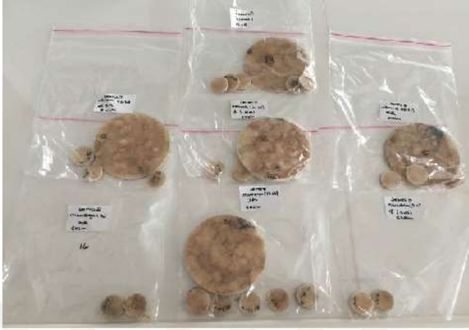
Şekil 27: Ses yutum testi için hazırlanan numuneler.
