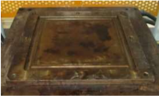
Şekil 19: Sıcak pres makinesinde kullanılan alt kalıp.
