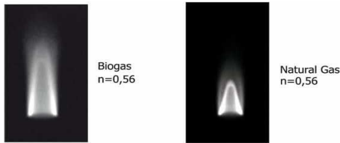
Şekil 2.6 Biyogaz ve doğalgazın alev yapılarının karşılaştırılması (Gonzalez et al., 2009).
