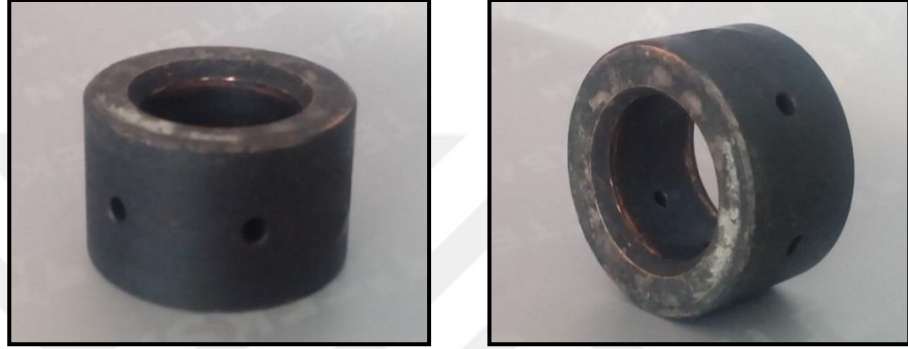
(c) 1500 saatlik kullanım sonrası turbo yataklarının görünümü.
