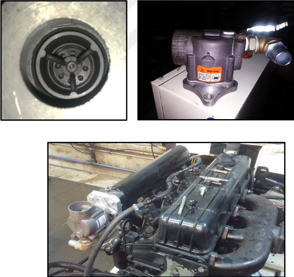
Şekil 4.15 Impco CA 55-5M-9 model mikser ve montajı.
