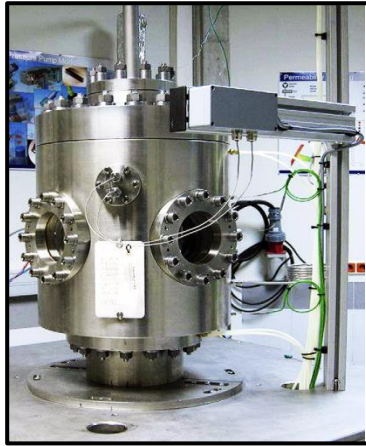
Şekil 3.4 Püskürtme odası ve temel çalışma düzeni (Kiesling, 2016).
