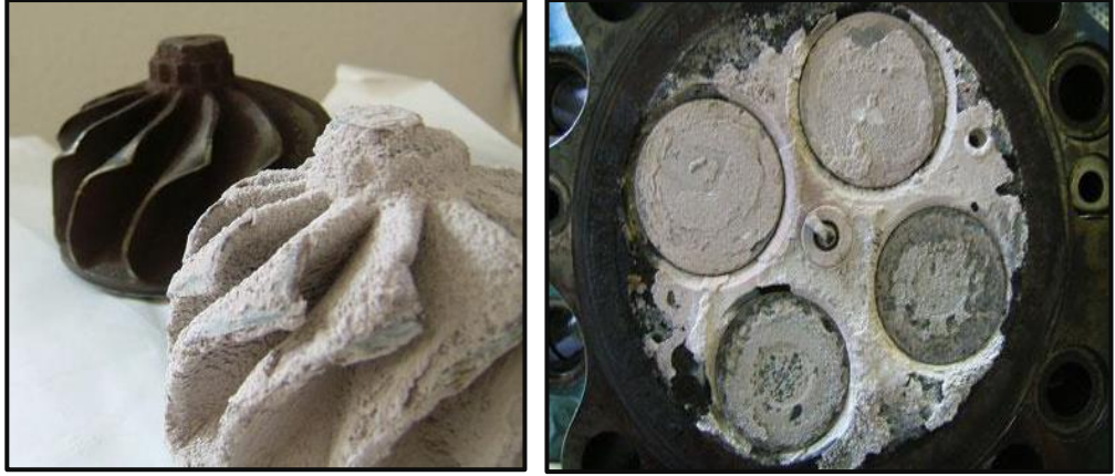
Şekil 2.7 Siloksanların motor parçaları üzerine etkileri (Florez and Egusquiza, 2015).
