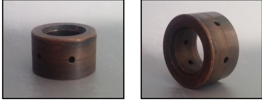
(b) 750 saatlik kullanım sonrası turbo yataklarının görünümü.
