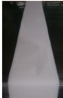
Şekil 3.87 : Fotokatalitik etkinliği belirlenmek üzere elektroeğirme makinasında üretilen geniş nanoweb resmi.
