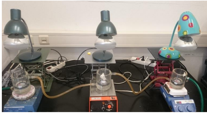
Şekil 3.94 : Fotokatalitik etkinlik ölçümü için hazırlanan deney düzeneği.
