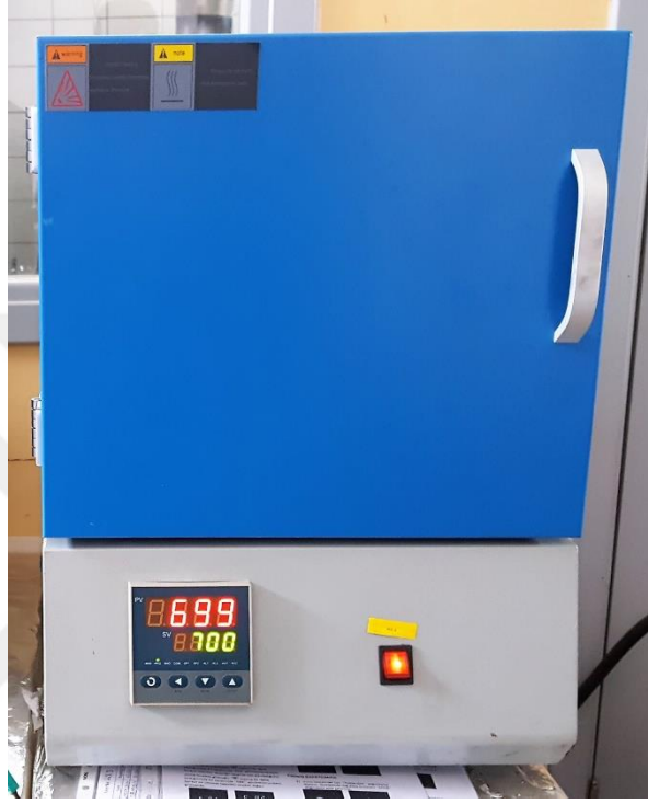
Şekil 6.2 : Oksidasyon testi yapılan kül fırını
