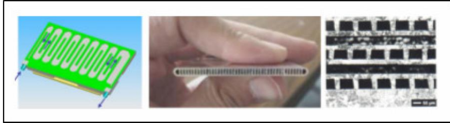
Şekil 1.5 : Isı değiştirici şematik gösterimi (solda), minikanallı ısı değiştirici (ortada), mikrokanallı ısı değiştirici (sağda).
