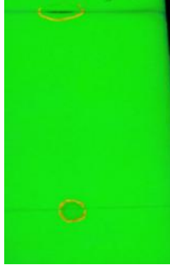
Şekil 4.81. [Pd(L3)(dppab)]Cl_2 bileşiğinin UV ışığı altında alınan TLC görüntüsü
