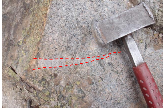
Şekil 4.12 Alaçam Plütönu içerisindeki aplit damarı (35N 644183-4364001)
