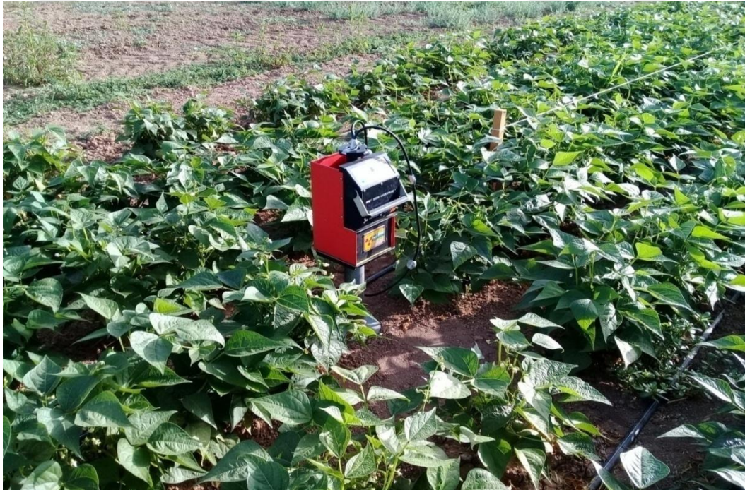
Şekil 3.7. Nötronmetre ile toprak neminin izlenmesi
