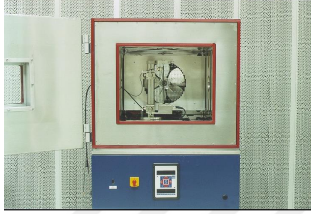
Şekil 2.31 : Termal odada Oberst düzeneği [31]
