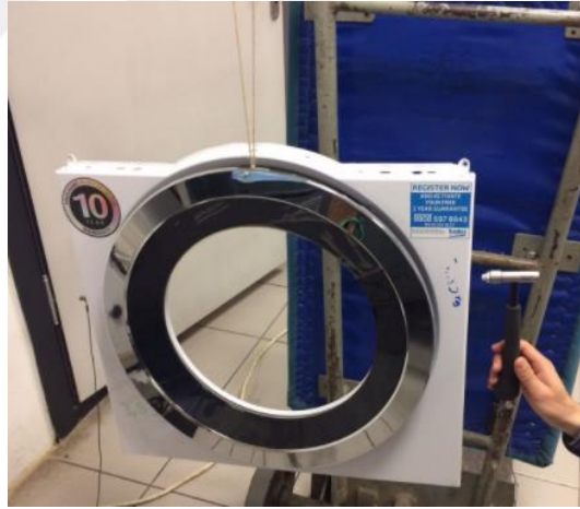
Şekil 4.5 : (1) numaralı parça olan kapakta çekiç testi yapılışı
