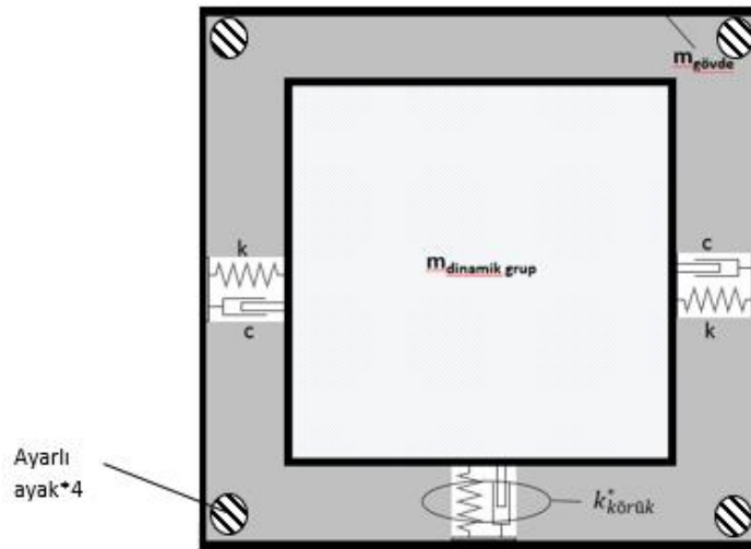
Şekil 2.1 : Çamaşır makinası indirgenmiş model görünümü
