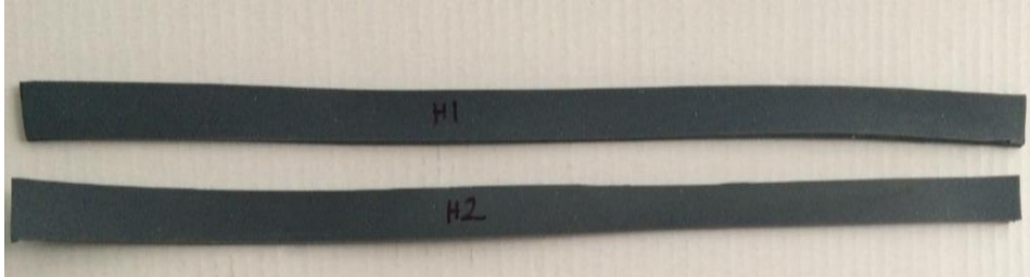
Şekil 3.5 : Standartlara uygun alınmış iki Oberst testi sönüm malzemesi numunesi
