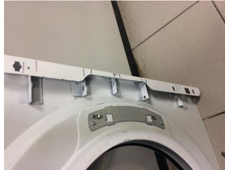
Şekil 4.3 : Kıvrılma bölgelerinde yapılan feder güçlendirmeleri
