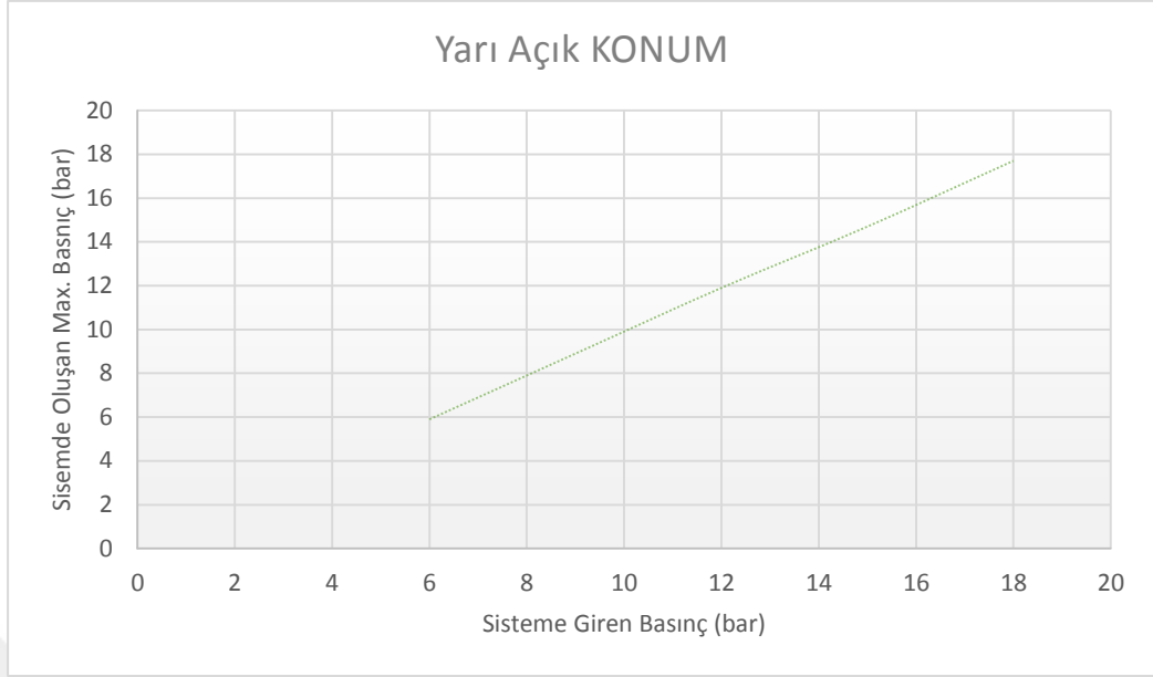
Şekil 7.8. Yarı açık konumda sistemdeki basınç değişimi
