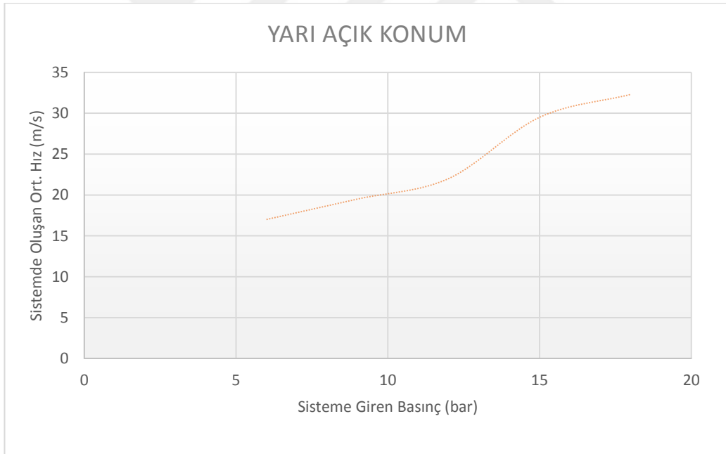
Şekil 7.9. Yarı açık konumda artan basınçla sistemdeki hız değişimi
