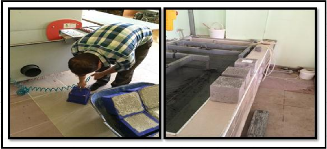
Şekil 3.11 Beton numunenin kalıptan çıkarılması ve kür havuzuna konması
