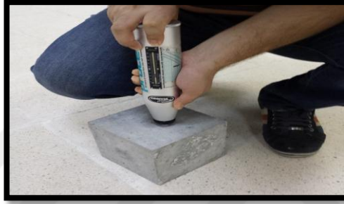
Şekil 3.13 Sertleşmiş betonda Schmidt çekici ile beton yüzey sertliği ölçümü
