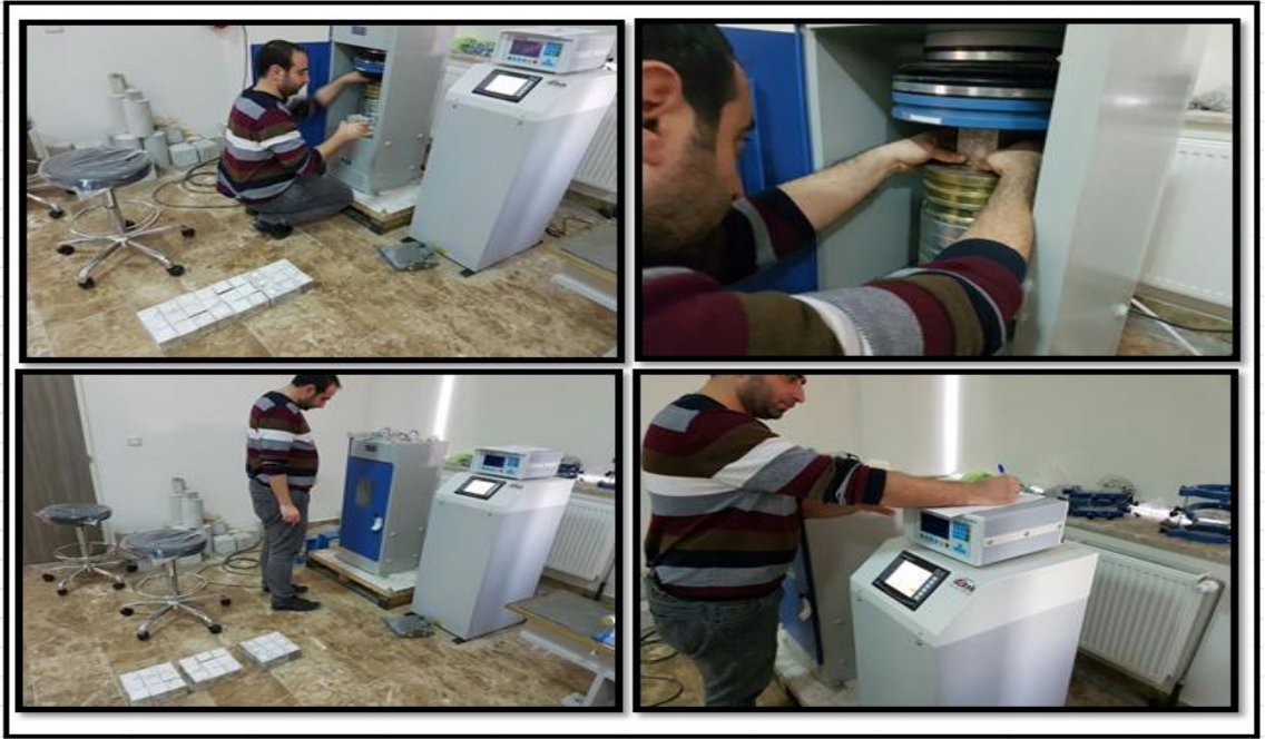
Şekil 3.14 Sertleşmiş betonun basınç dayanım değerleri ölçümü
