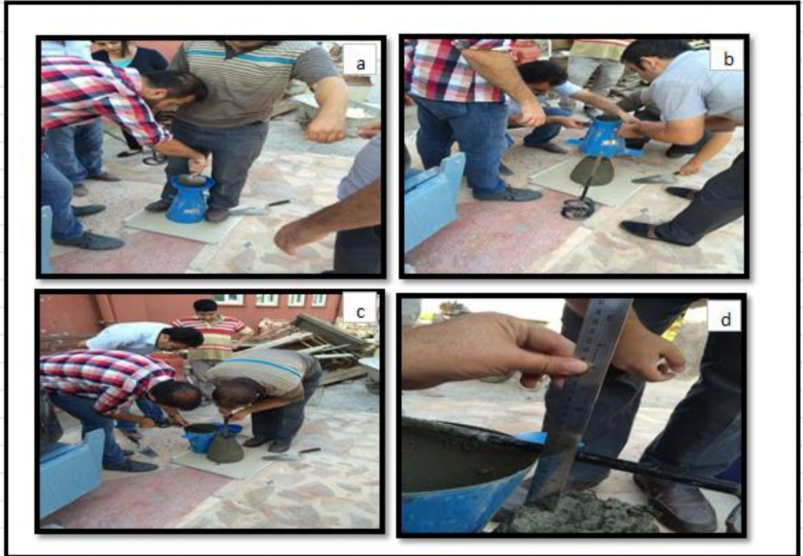
Şekil 3.9. a: Huniye malzeme yerleştirilmesi; b: Malzemenin yavaşça çekilmesi; c ve d: Çökme miktarının ölçülmesi
