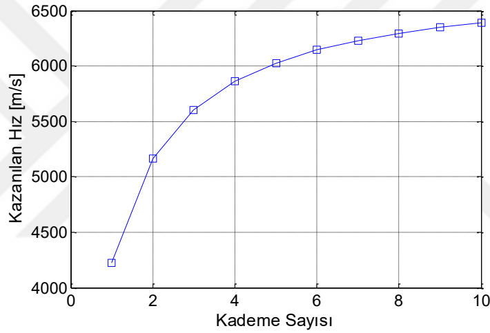
Şekil 7.8 : Roket Kademe Sayısının Sistem Verimi Üzerine Etkisi.
