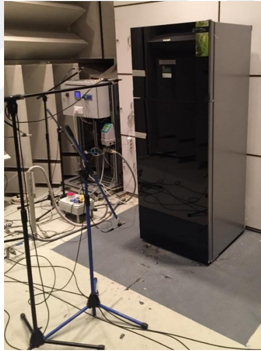
Şekil 4. 5 Buzdolabı ses gücü düzeyi ölçüm düzeneği
