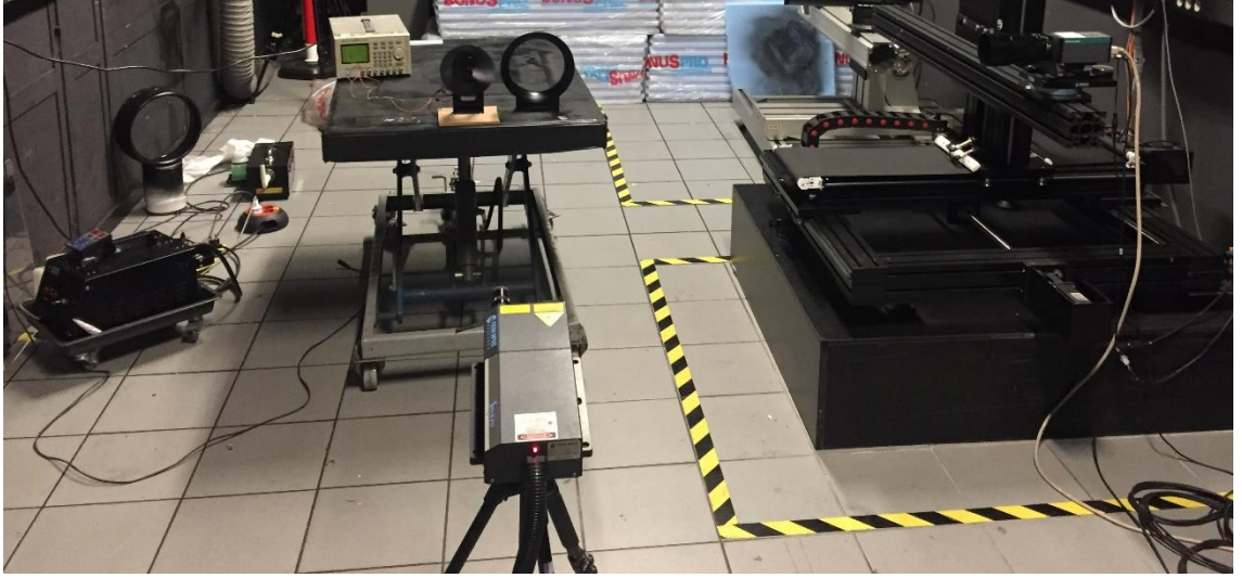
Şekil 4. 8 PIV deneyi ölçüm düzeneği
