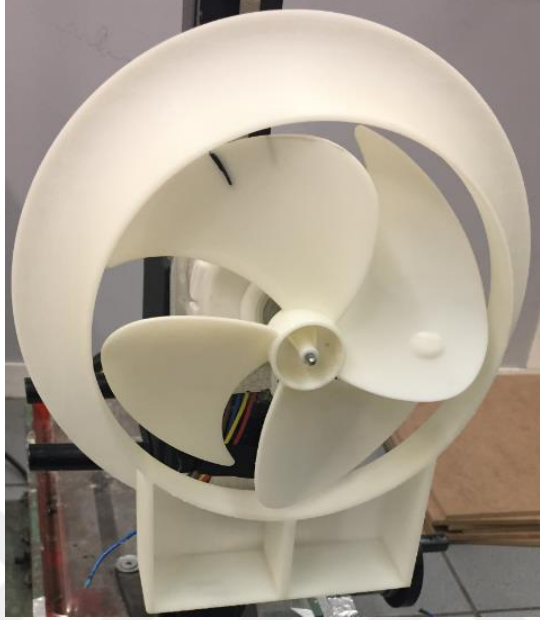
Şekil 6. 2 SLA'dan yapılmış hava yönlendirici prototipi
