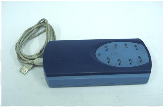
Şekil 2.11. Sıcaklık değişimlerinin kaydedilmesinde kullanılan sıcaklık kaydedicisi.
