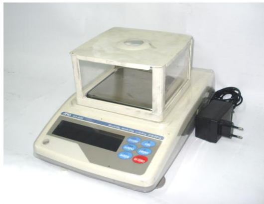
Şekil 2.9. Alaşım metallerinin tartılmasında kullanılan hassas terazi.
