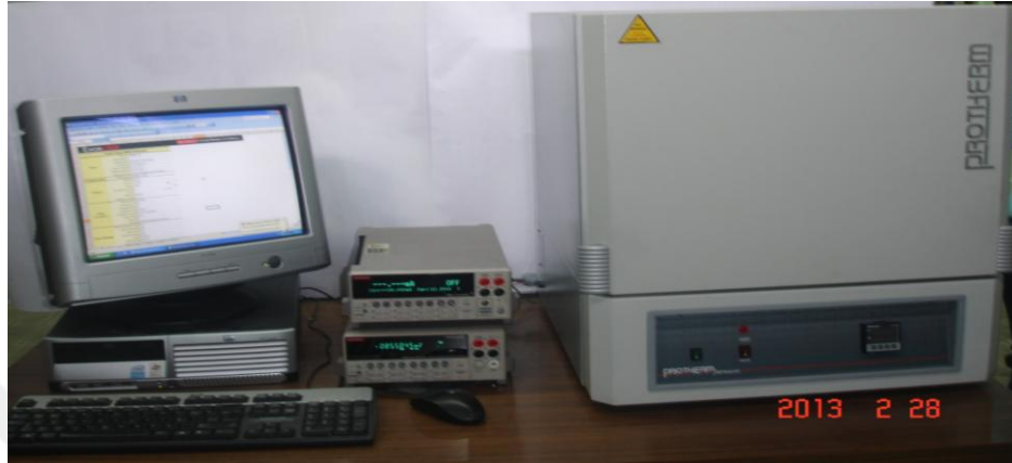
Şekil 2.25. Elektriksel iletkenlik ölçüm düzeneği.
