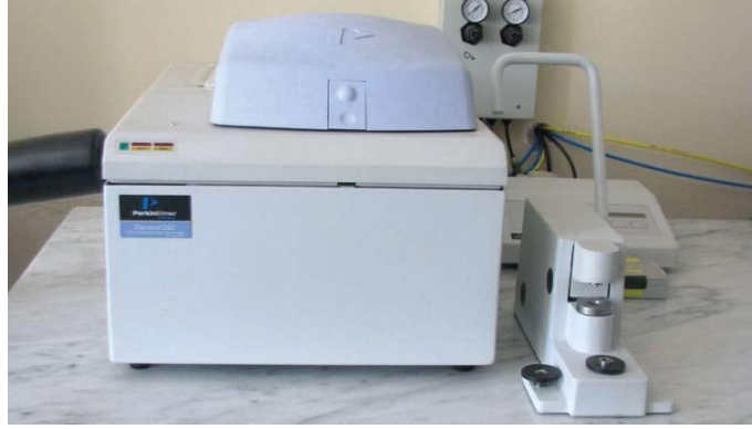
Şekil 2.26. Diferansiyel taramalı kalorimetre cihazı.
