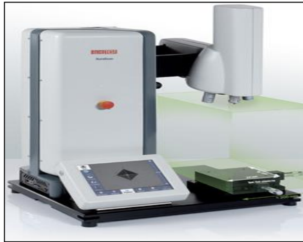
Şekil 2.23 Mikrosertlik ölçüm cihazının fotoğrafı.
