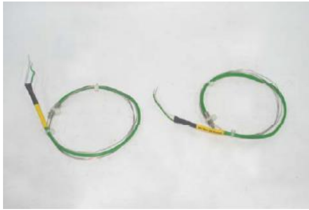
Şekil 2.33. Numunelerin ısıl iletkenlik, katılaştırma hızı ve soğuma eğrisi ölçümünde kullanılan termal çiftler [221].
