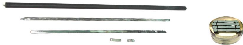
Şekil 2.16. Numune için, numune kalıbının oluşturulmasından epoksi- resin ile kalıplanması sürecine kadar ki her bir aşamanın gösterimi.
