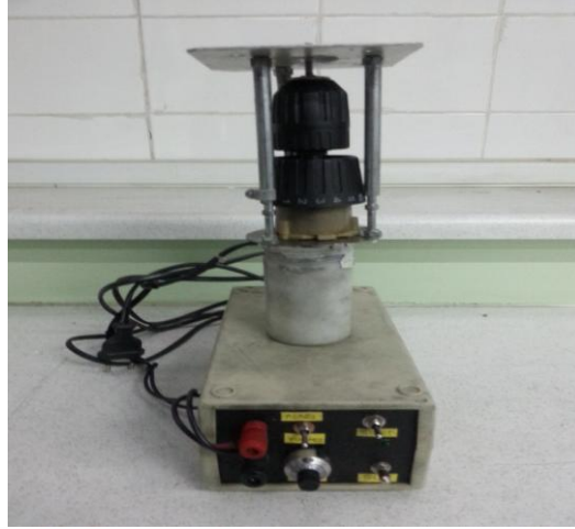
Şekil 2.15. Yüksek katılaştırma hızlarına çıkabilmek için özel olarak dizayn edilmiş çekme motoru fotoğrafı.
