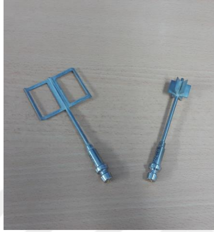
Şekil 3.7. Reometri ölçüm uçları (sol: ST59-2V-44.3/120 stirrer; sağ: ST22-6V-16/106 stirrer)
