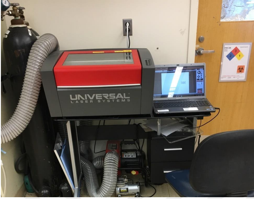
Şekil 3.2.1. Kağıt tabanlı mikroçiplerin eldesi için kullanılan lazer kesici (VLS2.30 system Universal Laser)
