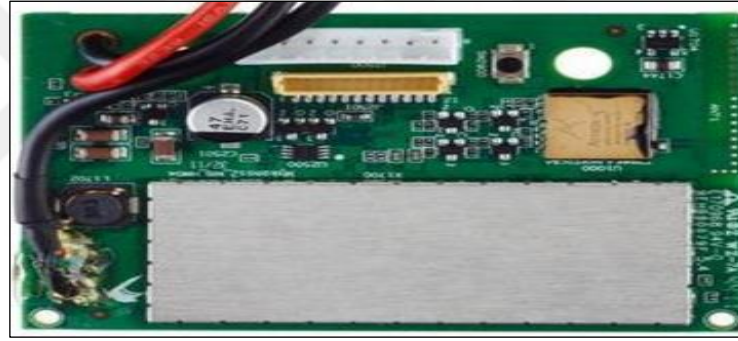
Şekil 5.4. AR.Drone hava aracının anakartı.
