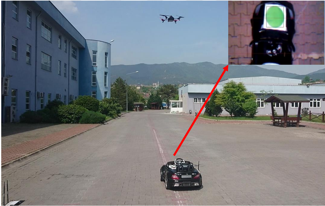
Şekil 6.16. Düz güzergah üzerinde yapılan hareketli ve seçili nesne takibine ait fotoğraflar.
