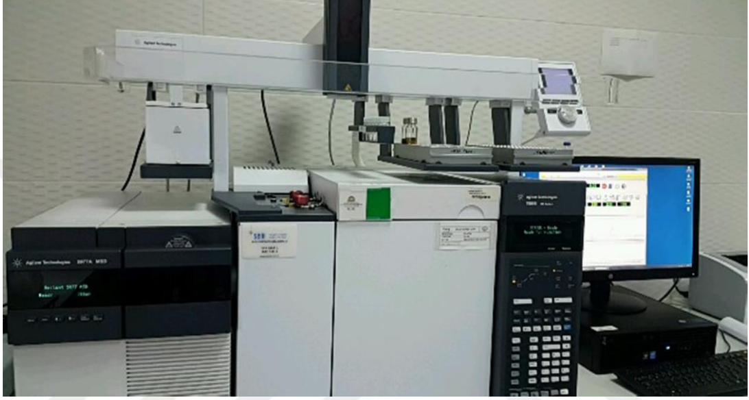
Şekil 3.10. Belirli yaprak örneklerine ait uçucu-aromatik bileşiklerin tespit edilmesinde kullanılan GC-MS cihazı
