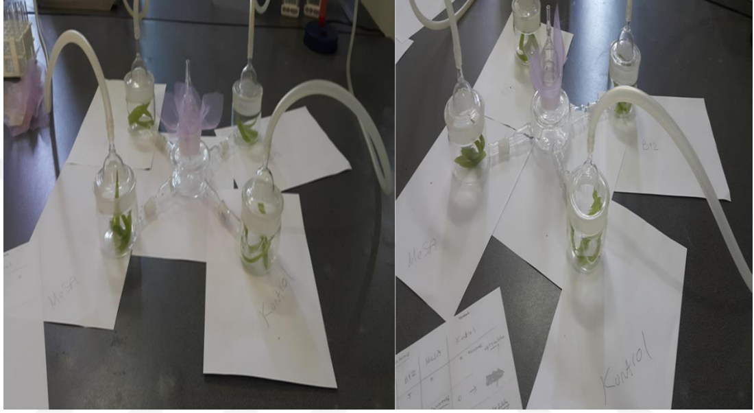
Şekil 3.16. Predatörlerin farklı koku kaynaklarına ait seçimlerinin belirlendiği 4 kollu olfaktometre
