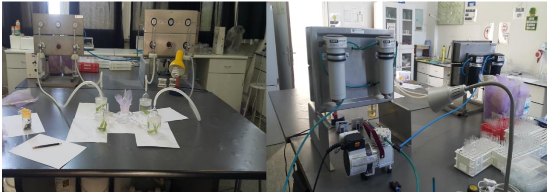
Şekil 3.11. Dört kollu olfaktometrenin ön den (hava filtrelerine bağlı 4 adet kol, kollara ait hazneler ve merkezi hazne) ve arkadan (2 adet hava filtresi, aktif karbon filtre) görünüşü
