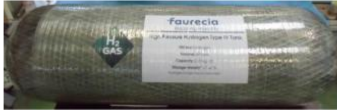
Görsel 5.20. Faurecia 700 bar hidrojen tankı [166]
