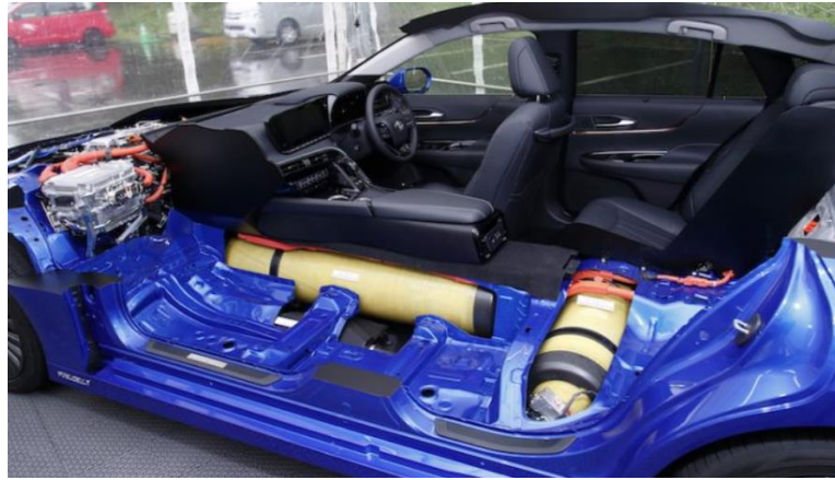
Görsel 5.21. Toyota Mirai yakıt hücreli otomobilde hidrojen tanklarının yerleşimi [167]
