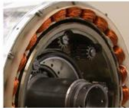
Görsel 3.5. DLR on-board ETS için tasarlanan çift aşamalı planet dişlinin görünüşü [91]
