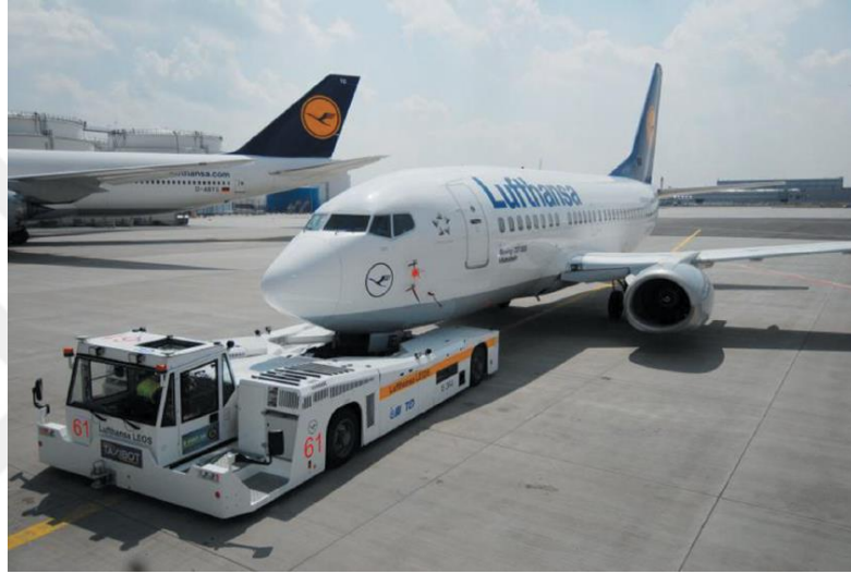
Görsel 3.2. Frankfurt havaalanında TaxiBot ile taksileme [30]
