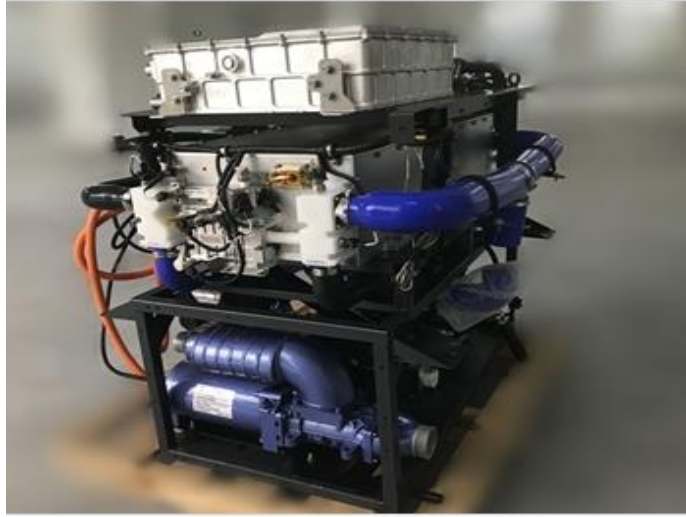
Görsel 5.6. Horizon VL 100 kW PEMFC [143]
