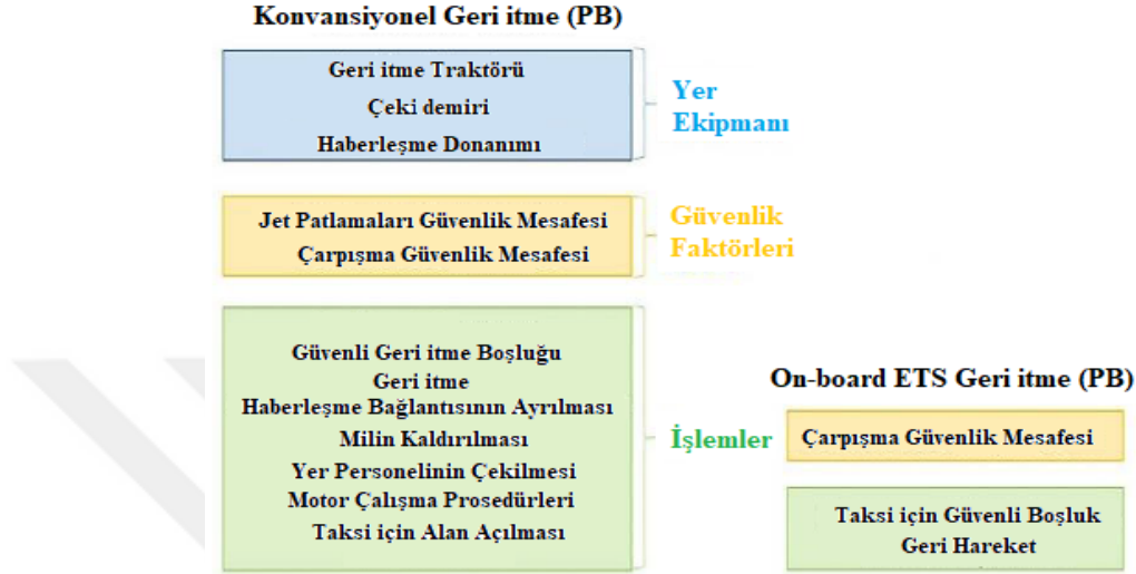
Görsel 3.10. Konvansiyonel olarak ve ETS ile yapılan geri itme (PB) hareketinin karşılaştırması [80]
