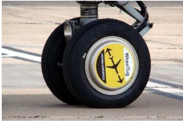
Görsel 3.4. Boeing 767 uçağın NLG kısmına WheelTug ETS'nin uygulandığı [28]
