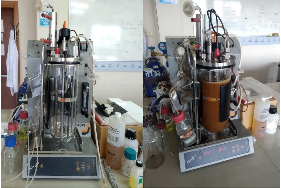
Şekil 2.2 Maya biyokütlesi üretmek için kullanılan biyoreaktör
