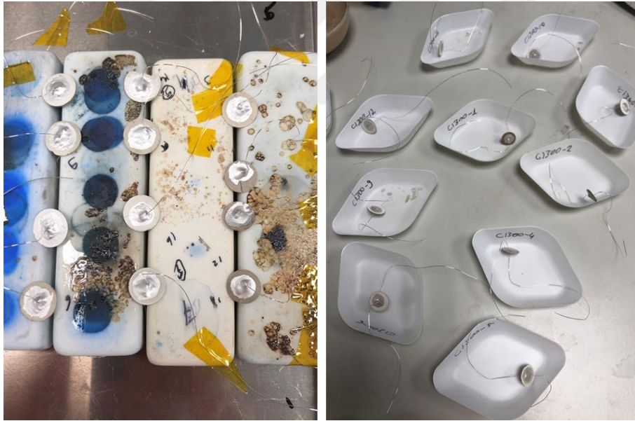
Şekil 3.19. Empedans analizi öncesi tabletleri ölçüme hazırlama.
