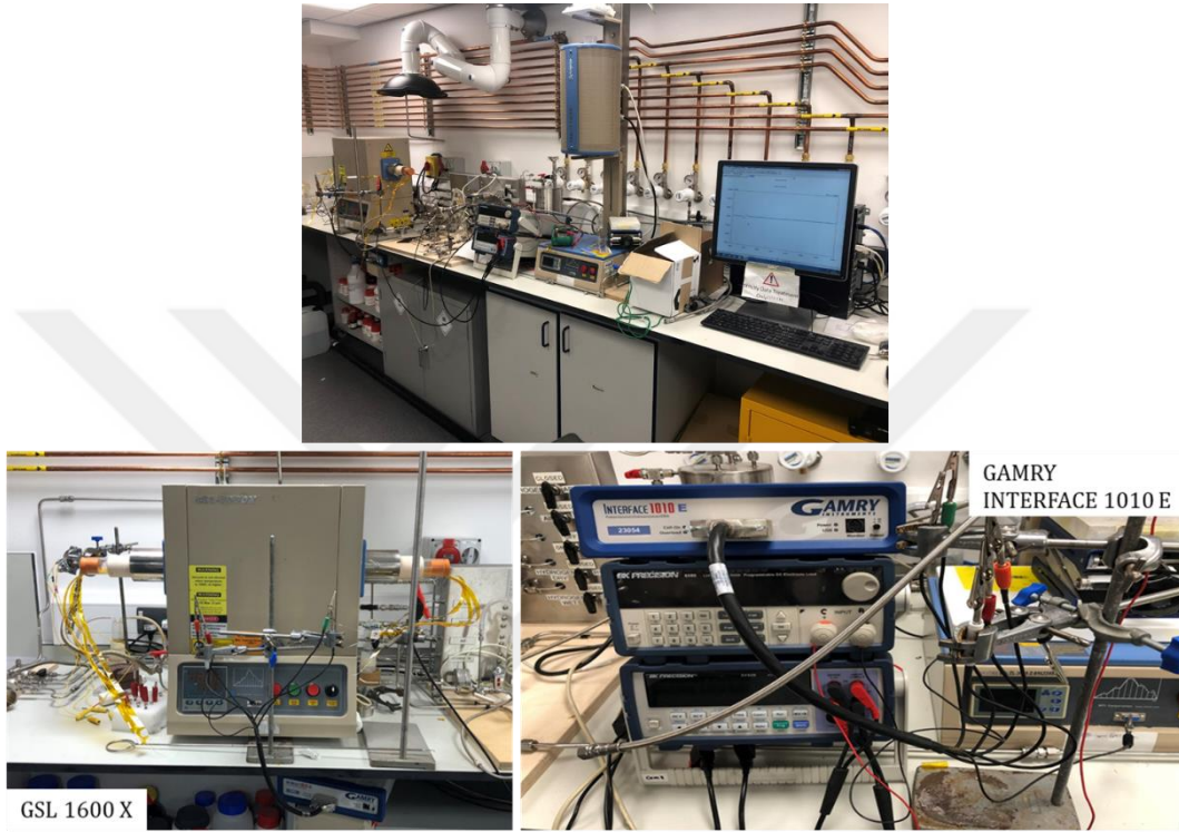
Şekil 3.21. Empedans analizi ölçüm düzeneği.
