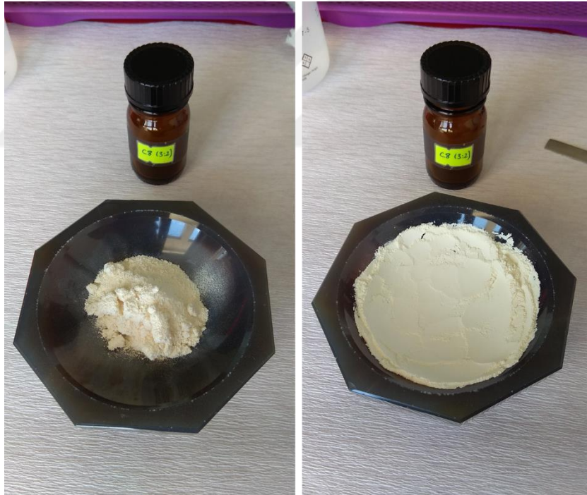
Şekil 3.3. Birinci kalsinasyon sonrası agat havanda öğütme işlemi.
