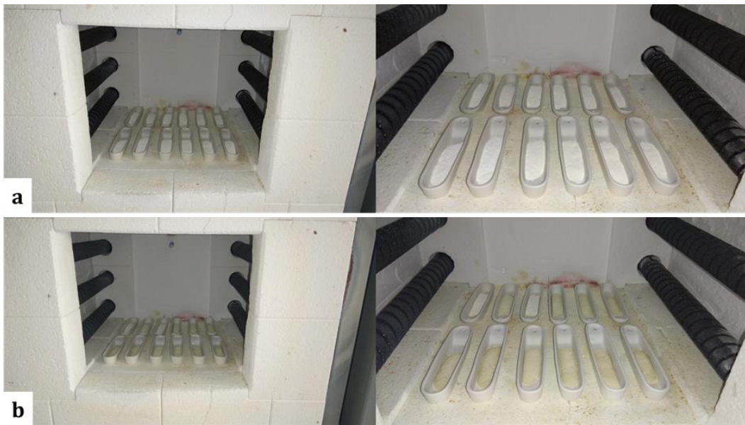
Şekil 4.5. 1300 °C'deki ikinci kalsinasyon öncesi(a) ve sonrası(b).
