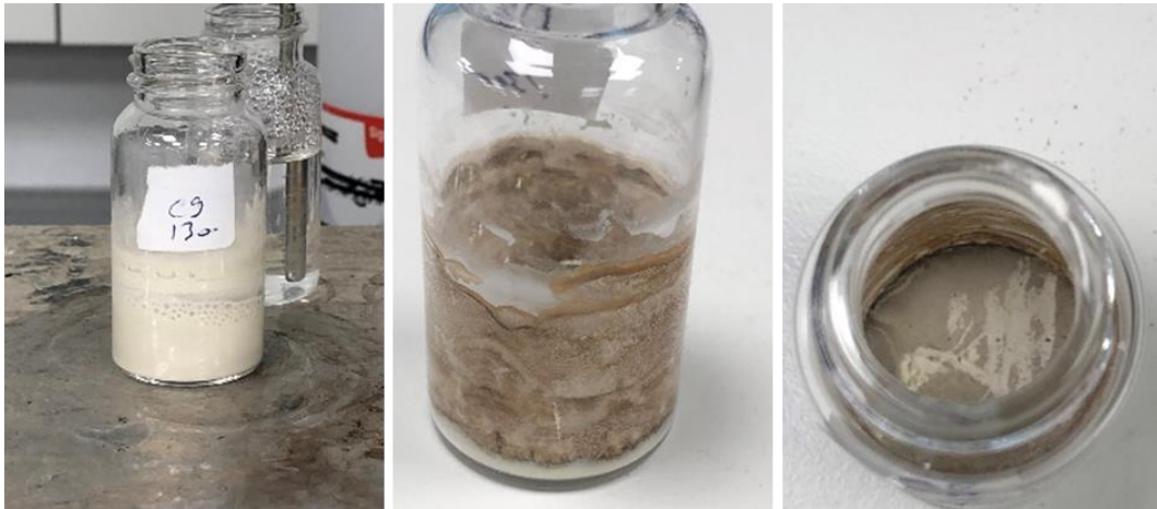
Şekil 3.16. Numuneleri PVA çözeltisi ile karıştırma ve kurutma işlemi.
