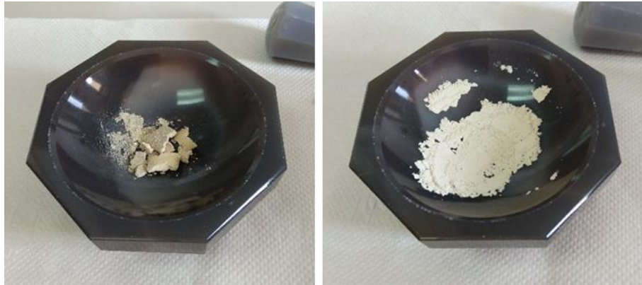
Şekil 3.5. 1300 °C’deki ikinci kalsinasyon işlemi sonrası agat havanda öğütme işlemi.
