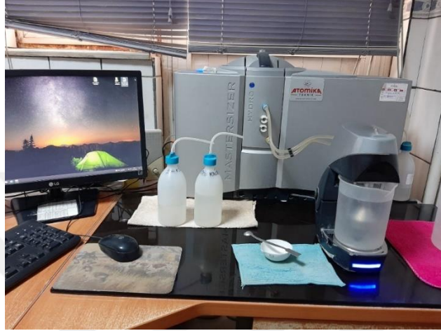
Şekil 3.4: Malvern Mastersizer 3000 HydroEV cihazı
