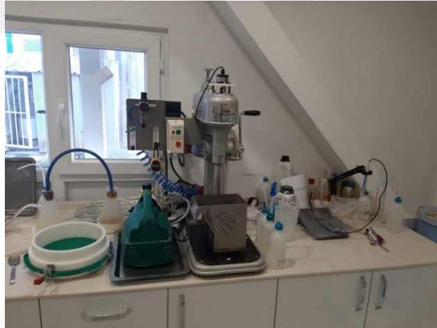
Şekil 3.5: Flotasyon cihazı ve Vakum filtre
