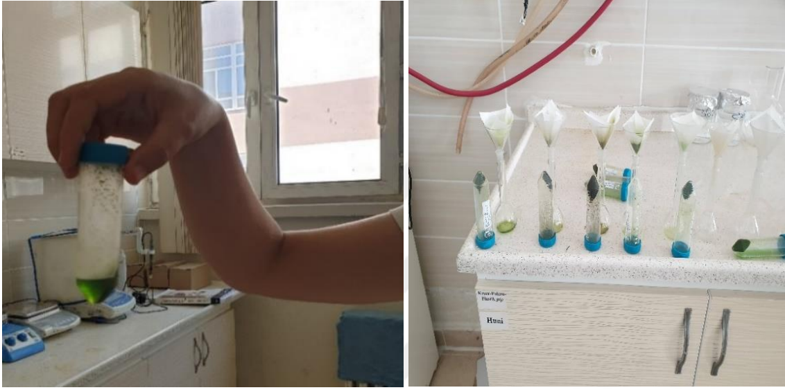
Şekil 3.47. Homojenizatörde parçalanma işlemi sonrası elde edilen çözelti ve oluşan çözeltinin kurutma kâğıdından geçirilerek süzdürme işleminin yapılması (E. Kına, Orijinal).
