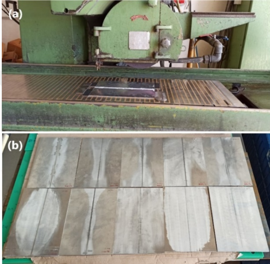
Şekil 4.4. Yüzey düzeltme işlemi: (a) Satıh taşlama yöntemiyle levha yüzeyinde biriken fazla soğuk sprej dolgu malzemesinin yüzeyden uzaklaştırılması, (b) taşlama işlemi sonrası ilk ölçüsüne getirilen sac levhalar.
