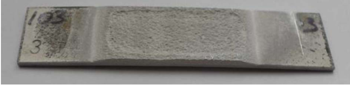
Şekil 3.13. Korozyon aşınmasının soğuk spreyle onarımı (Shikalov vd., 2017).
