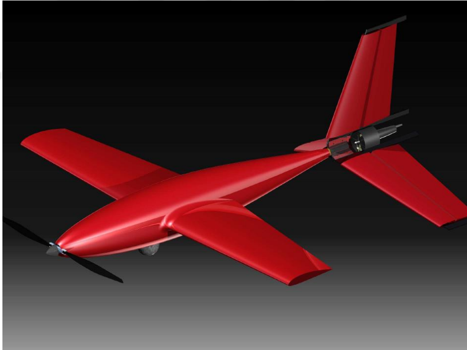
Şekil 1.2 ITU-BYU tailsitter VTOL İHA (Aksugur ve diğer., 2008)
