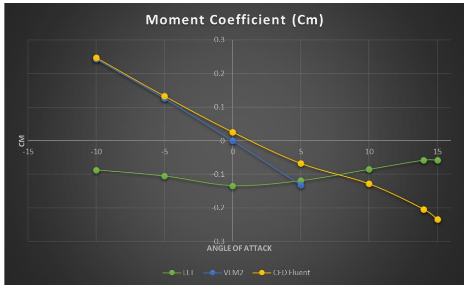
Şekil 3.51 Moment katsayısı C_m hücum açısı ile değişimi karşılaştırması
