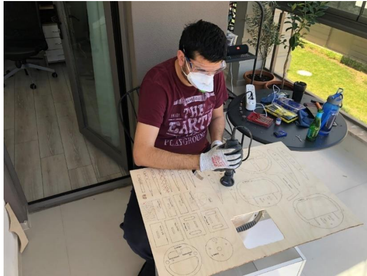
Şekil 4.2 Huş kontraplaktan parça kesimi (Kişisel arşiv, 2020)
