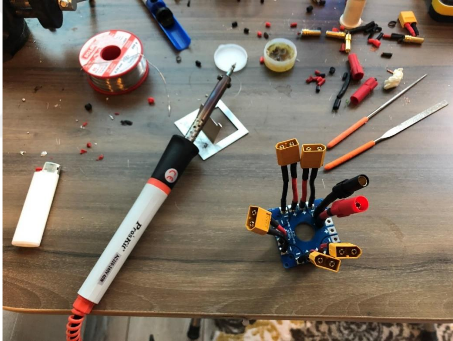
Şekil 4.13 Güç dağıtım ünitesinin üretilmesi (Kişisel arşiv, 2021)
