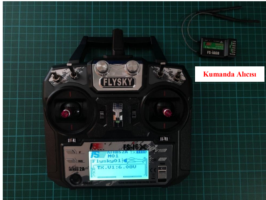
Şekil 3.19 Kumanda ve kumanda alıcısı (Kişisel arşiv, 2019)
