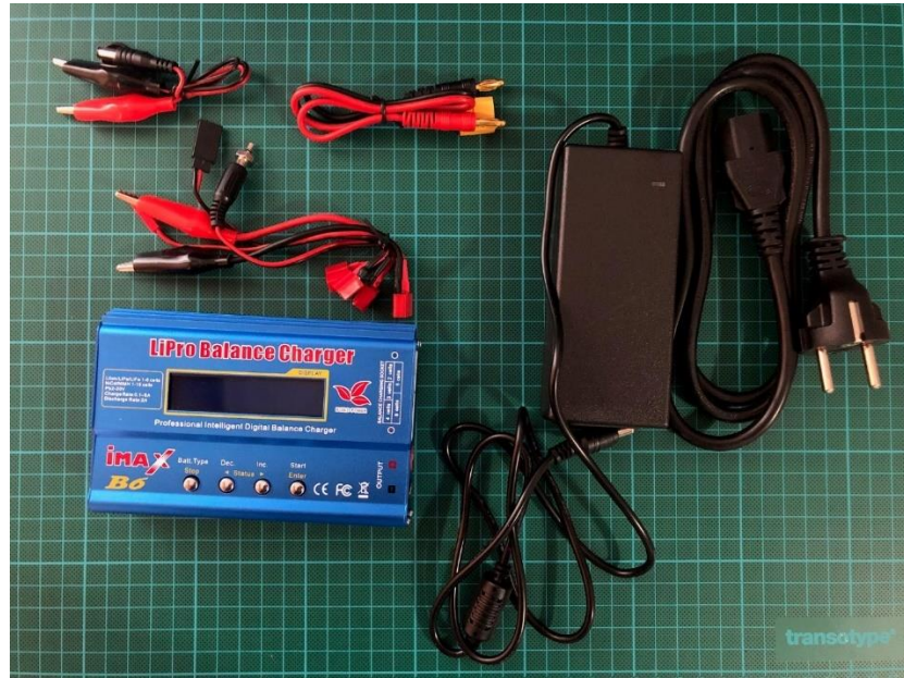
Şekil 3.8 Lipo batarya şarj aleti (Kişisel arşiv, 2019)
