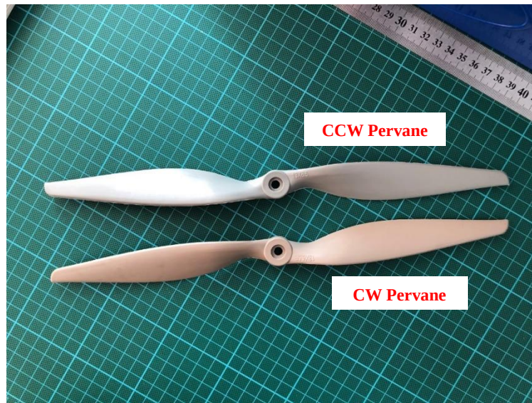
Şekil 3.4 CCW ve CW APC pervaneler (11 x 5,5 inch) (Kişisel arşiv, 2019)
