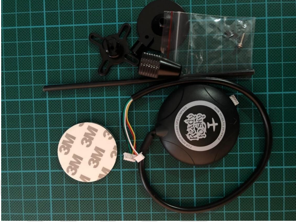
Şekil 3.12 GPS-pusula sensörü ve bağlantı aparatı (Kişisel arşiv, 2019)
