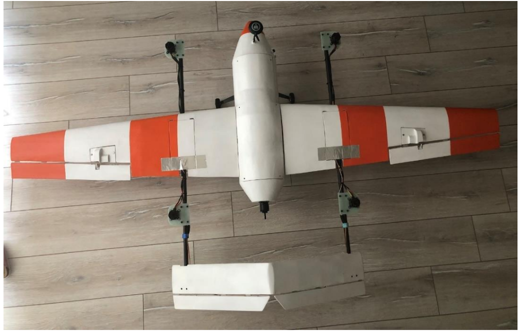
Şekil 4.12 Boyama sonrası montajlanmış hava aracı (Kişisel arşiv, 2021)
