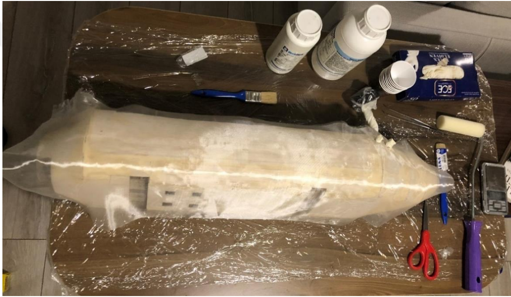
Şekil 4.8 Laminasyon işlemi öncesi hava aracının gövdesi (Kişisel arşiv, 2021)
