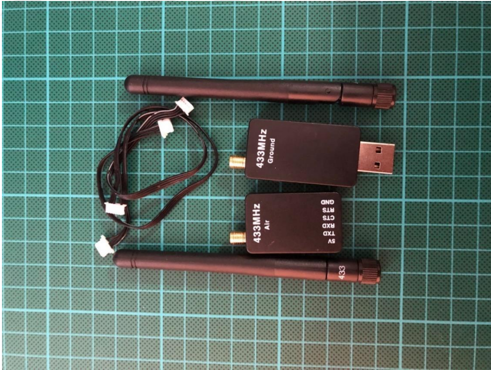
Şekil 3.11 Telemetry alıcısı ve vericisi (Kişisel arşiv, 2019)
