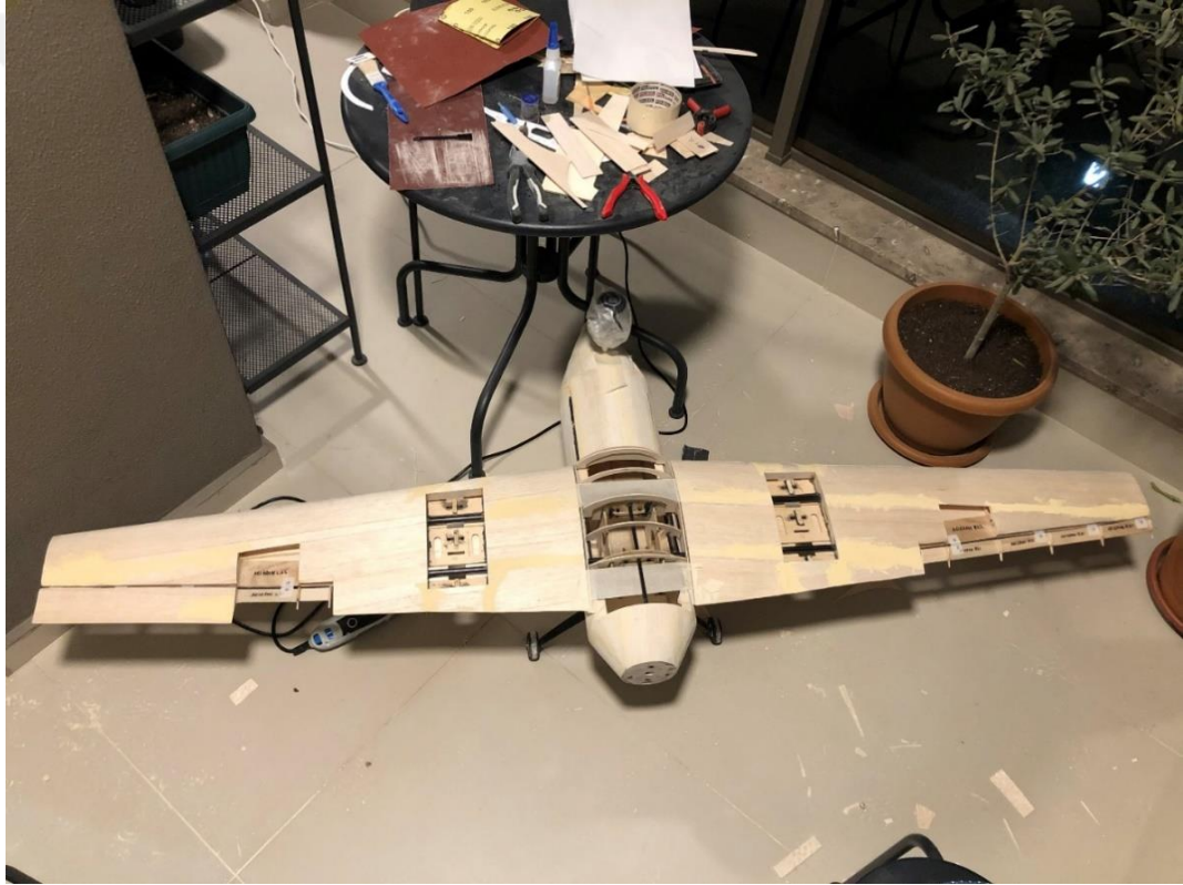
Şekil 4.7 Balsa kaplama ve macunlama (Kişisel arşiv, 2020)
