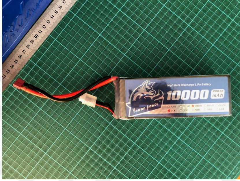
Şekil 3.7 Yowoo 10000 mAh 4S lipo batarya (Kişisel arşiv, 2019)
