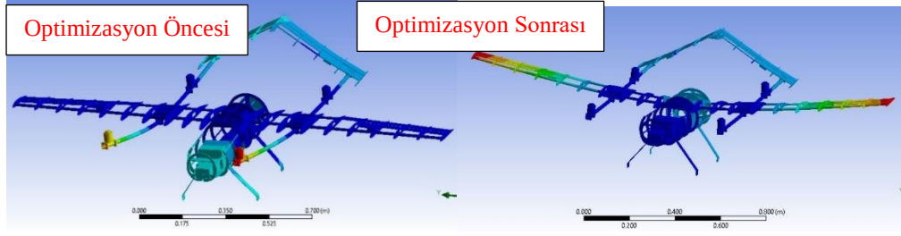
Şekil 3.37 Modal analiz 9. mod karşılaştırma
