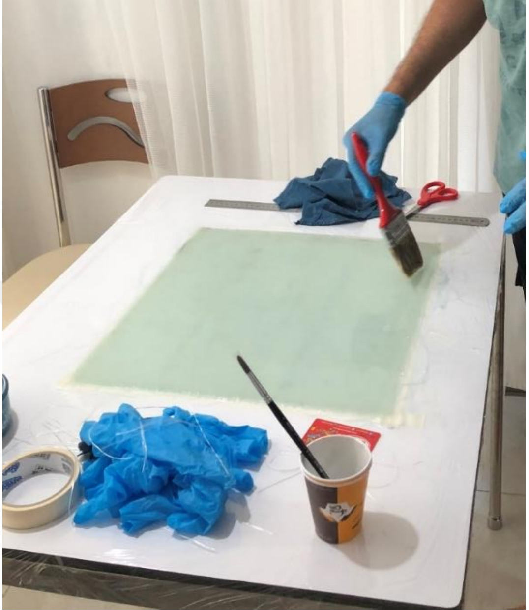
Şekil 4.10 Cam elyaf – epoksi kompozit plakanın elle yatırma ile üretilmesi (Kişisel arşiv, 2021)
