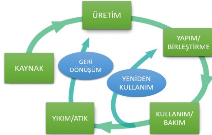
Şekil 3.4: Yapı parçalarının geri kazanım olanakları.
