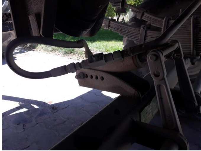
Şekil 3.2. Yön kontrol valfinin tarım arabası üstündeki görüntüsü
