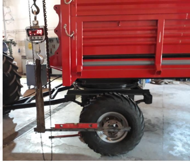
Şekil 3.4. Statik durumda teker fren momenti ölçüm sistemi uygulama görüntüsü
