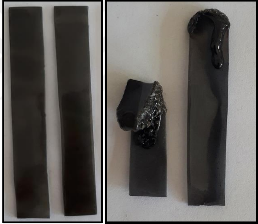
Şekil 5.10. PS-Ağ.0.45 % Gr içeren kompozitin yanma öncesi ve sonrası görüntüsü
