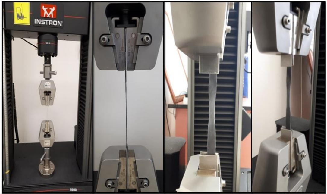
Şekil 4.10. Instron 5982 100 kN zemin modeli çekme cihazı
