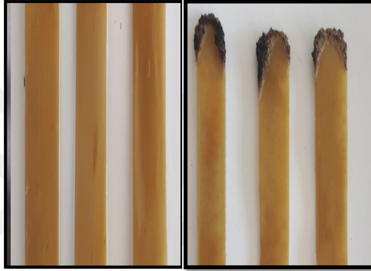
Şekil 5.11. PS-Aerojel içeren kompozitin yanma öncesi ve sonrası görüntüsü
